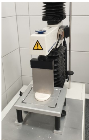
Obr. 9 – měření tvrdosti laskonky za použití Warner – Bratzlerova nože [zdroj: vlastní]
