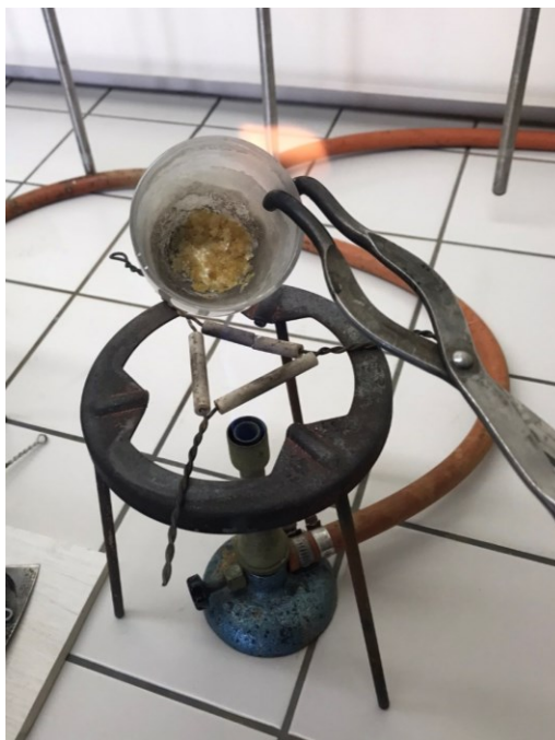
Obrázek 78 Stanovení obsahu popelovin – proces spalování vzorku
