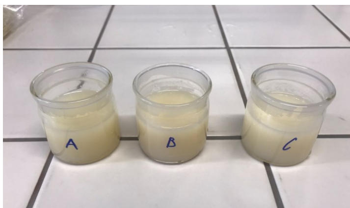
Obrázek 80 Stanovení pevnosti gelu – příprava 6,67% roztoku želatiny
