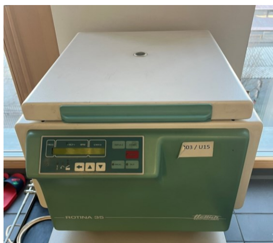
Obrázek 89 Stanovení tuk vázací kapacity – odstředivka ROTINA 35
