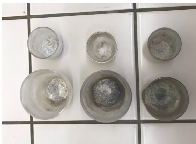
Obrázek 79 Stanovení obsahu popelovin – spálené a vysušené vzorky
