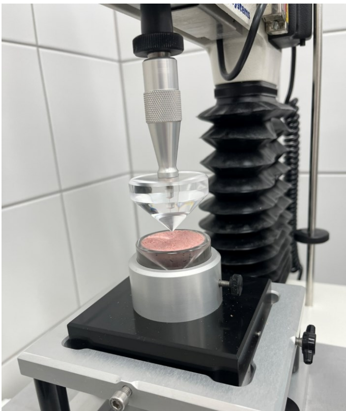
Obrázek 118 Vzorek připravený pro měření na texturometru
