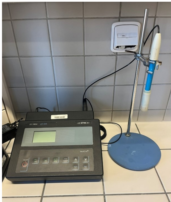
Obrázek 69 pH metr – pH Meter pH 526
