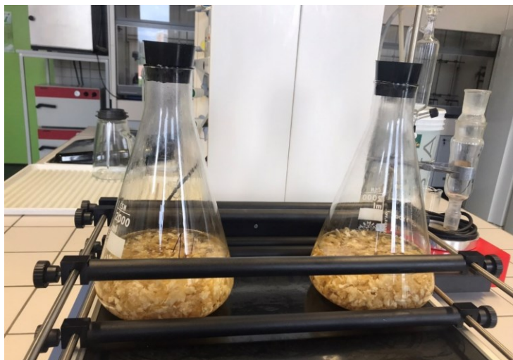
Obrázek 65 Odtučňování suroviny na třepačce
