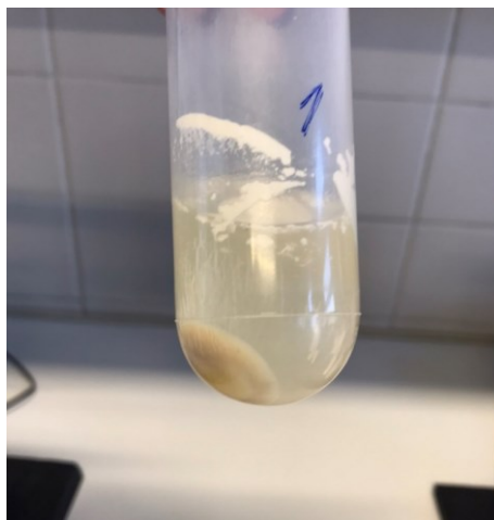
Obrázek 27 Vzorek želatiny po odstředění pro stanovení vodu zadržující kapacity
