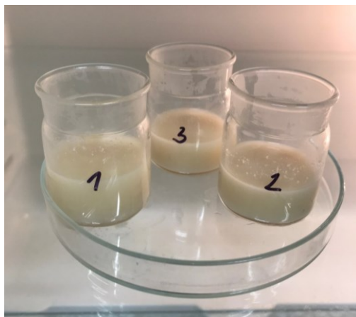
Obrázek 81 Stanovení pevnosti gelu – chlazení připraveného želatinového roztoku
