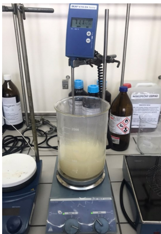
Obrázek 71 Dodatečné zahřívání při extrakci želatiny
