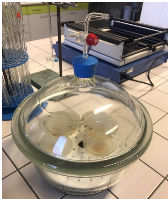
Obrázek 77 Stanovení obsahu sušiny – vzorky v exsikátoru
