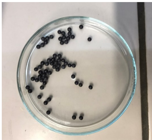
Obrázek 84 Stanovení teploty tuhnutí – kovové kuličky
