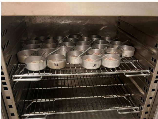
Obrázek 32 Vzorky paštik při procesu sušení v sušárně
