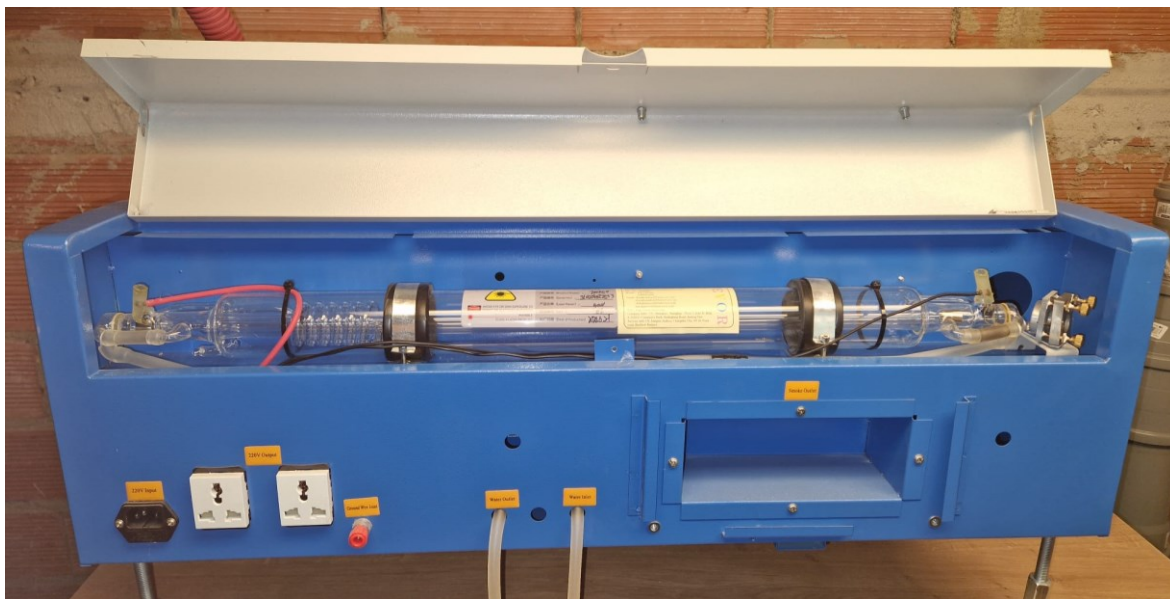
Obrázek 7 Zdroj paprsku CO 2 modelářského laseru K40
