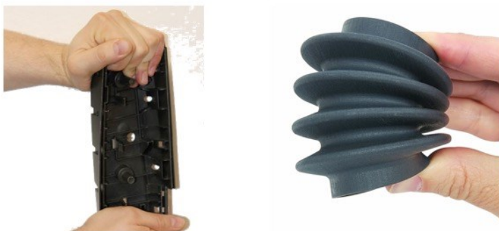
Obr. 9 Chování polymerů při zatížení: plast (vlevo), elastomer (vpravo) [7]
