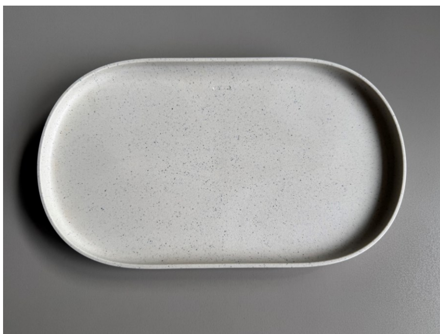
Obrázek 77 Ukázka materiálu – polypropylen s příměsí kávové sedliny
