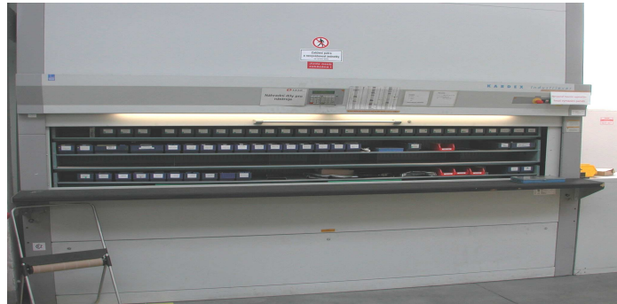
Obr. 24. Skladový systém náhradních dílů Paternoster
