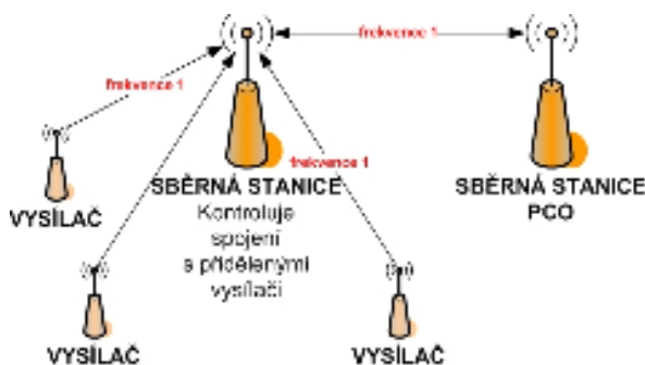
Obrázek č.: 9 – Decentralizovaná rádiová síť jednofrekvenční
