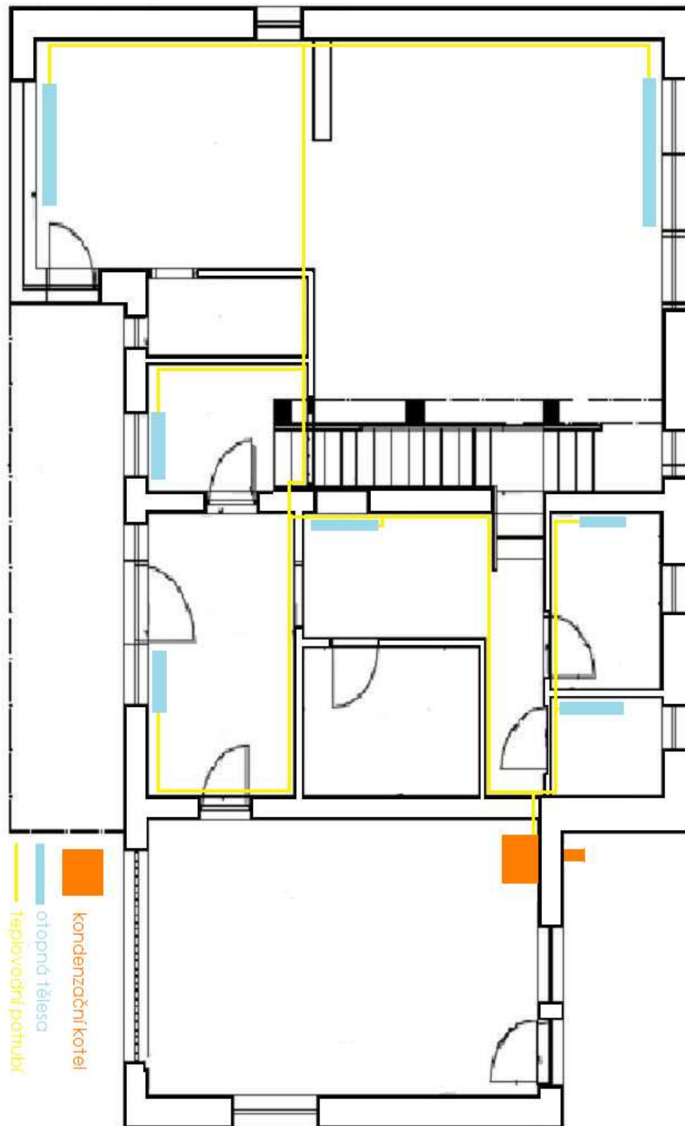
Obr. 53: rozvod potrubí otopné soustavy v 1.NP
