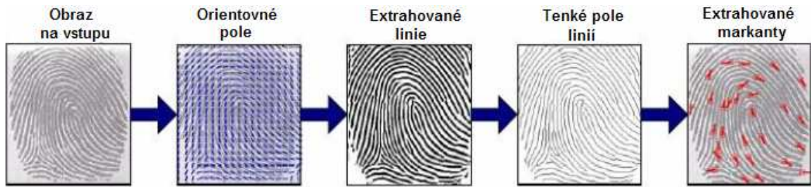
Obr. 20. znázornění algoritmu pro zpracování otisku
