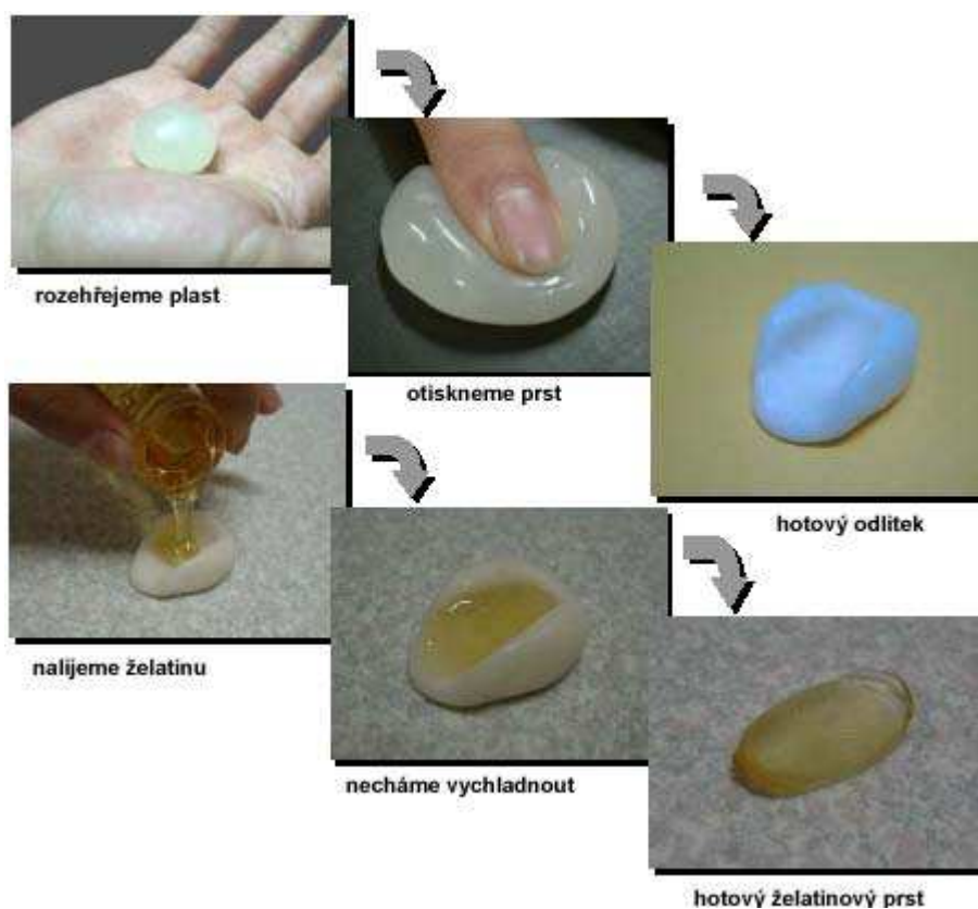
Obr. 6. Postup zhotovení želatinového odlitku prstu [9]
