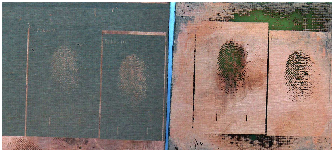
Obr. 42. Vyvolaný otisk na DPS (vlevo), vyleptaná DPS s otiskem (vpravo)
