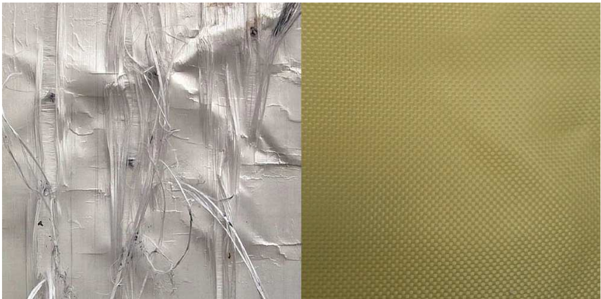
Obr. 19. Srovnání struktury Dyneemy (vlevo) a Kevlaru (vpravo)
