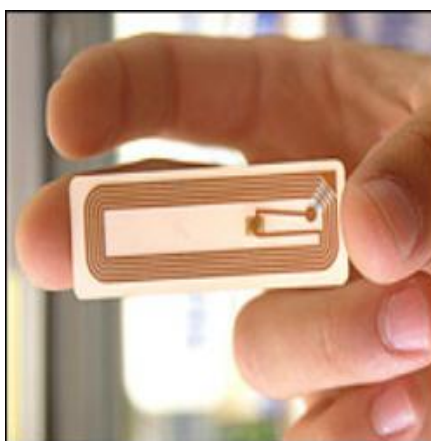
Obrázek 29: Radiofrekvenční identifikační čip (RFID) [15]
