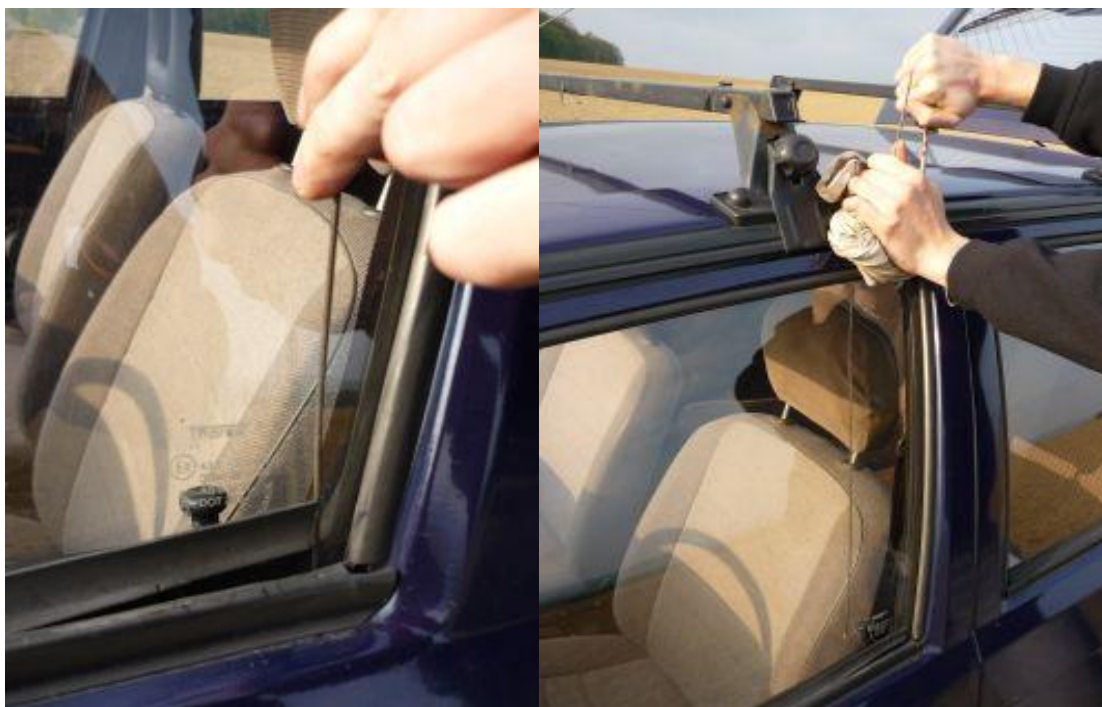
Obrázek 34: Vyháčkování uzamykacího mechanismu [vlastní]
