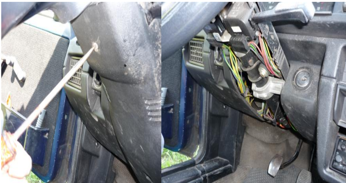
Obrázek 35: Sejmutí ochranného krytu volantu [vlastní]
