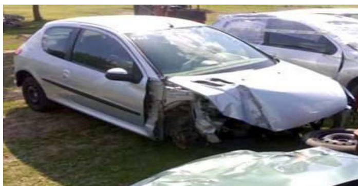
Obrázek 20: Vozidlo Peugeot bourané na pravou přední část [9]
