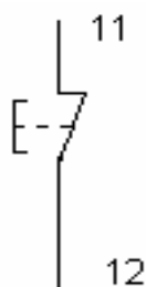
Obr. 33. Značka tlačítkového vypínacího kontaktu
