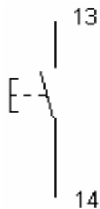
Obr. 32. Značka tlačítkového spínacího kontaktu
