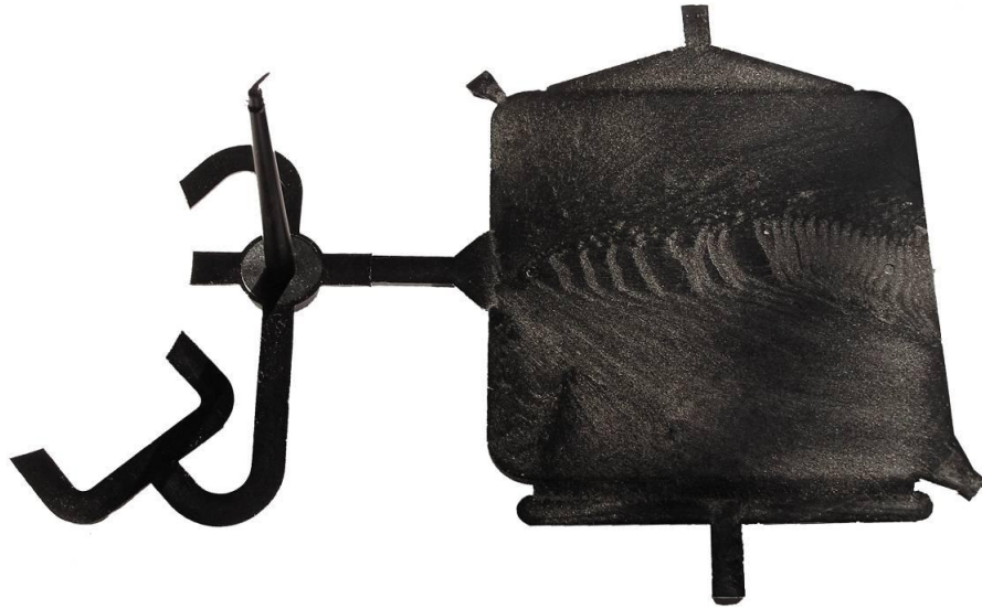
Obr. 83 PA66 + 30 % skelných vláken – konečný výrobek s bočním vtokem
