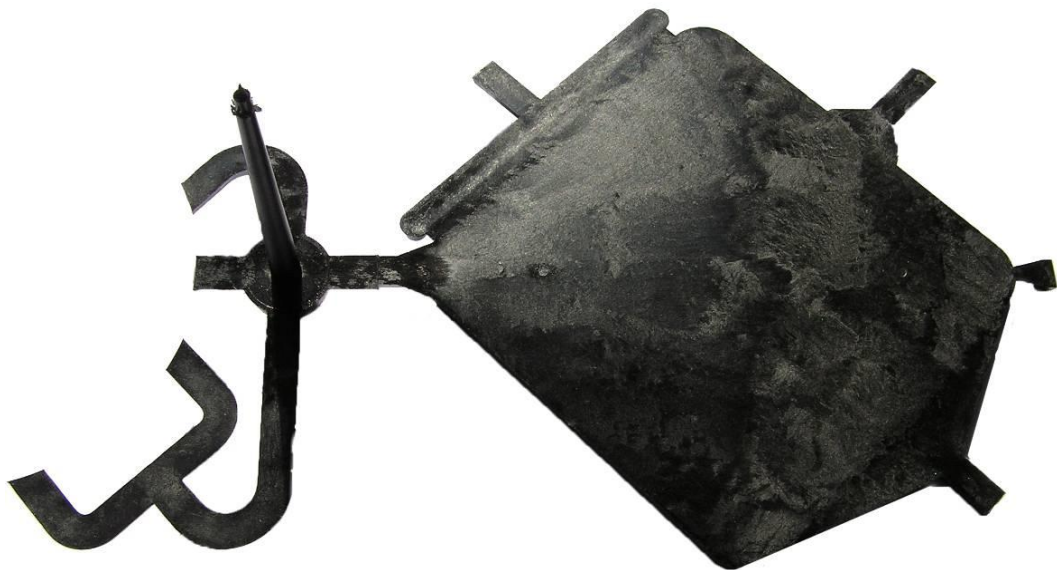
Obr. 91 PA66 + 50 % skelných vláken – konečný výrobek s rohovým filmovým vtokem
