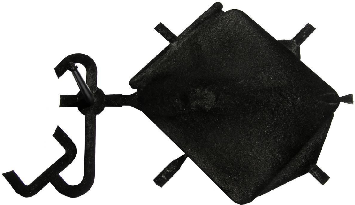
Obr. 87 PA66 + 35 % skelných vláken – konečný výrobek s rohovým filmovým vtokem
