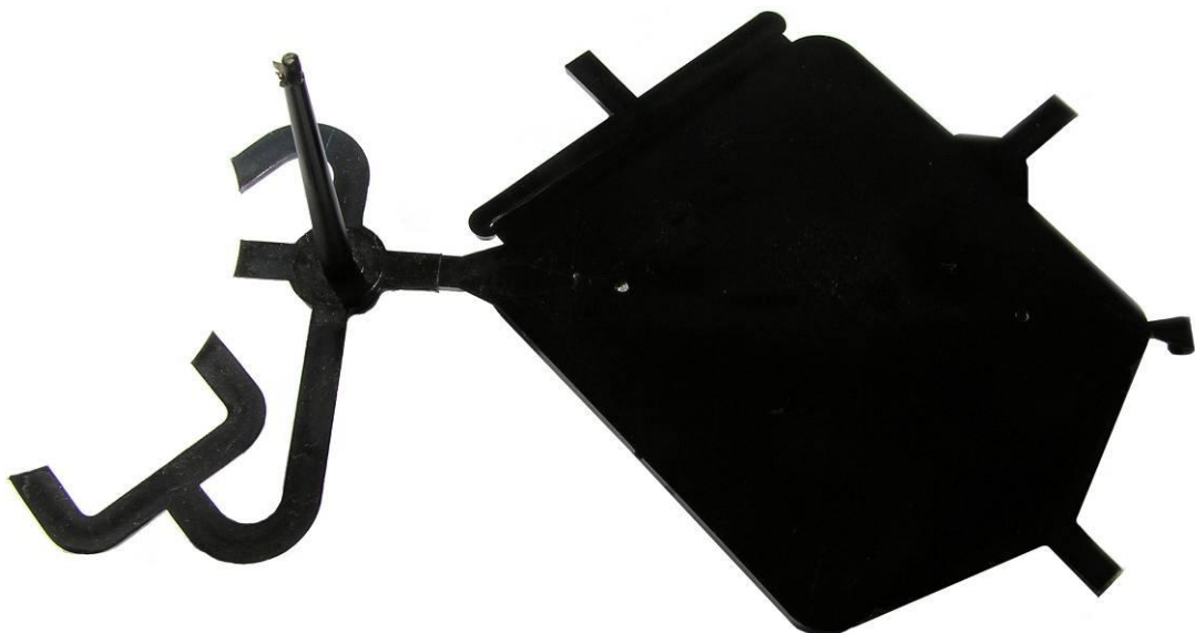
Obr. 74 PA66 – konečný výrobek s rohovým filmovým vtokem
