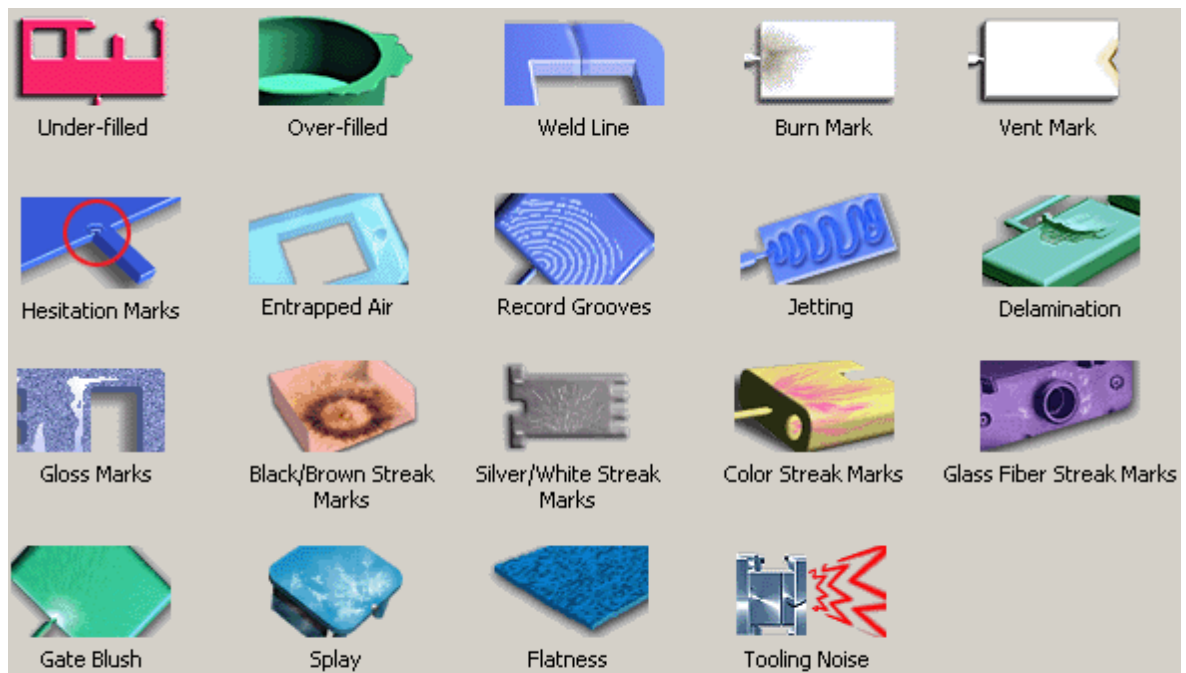
Obr. 35 Možné závady na výrobku
