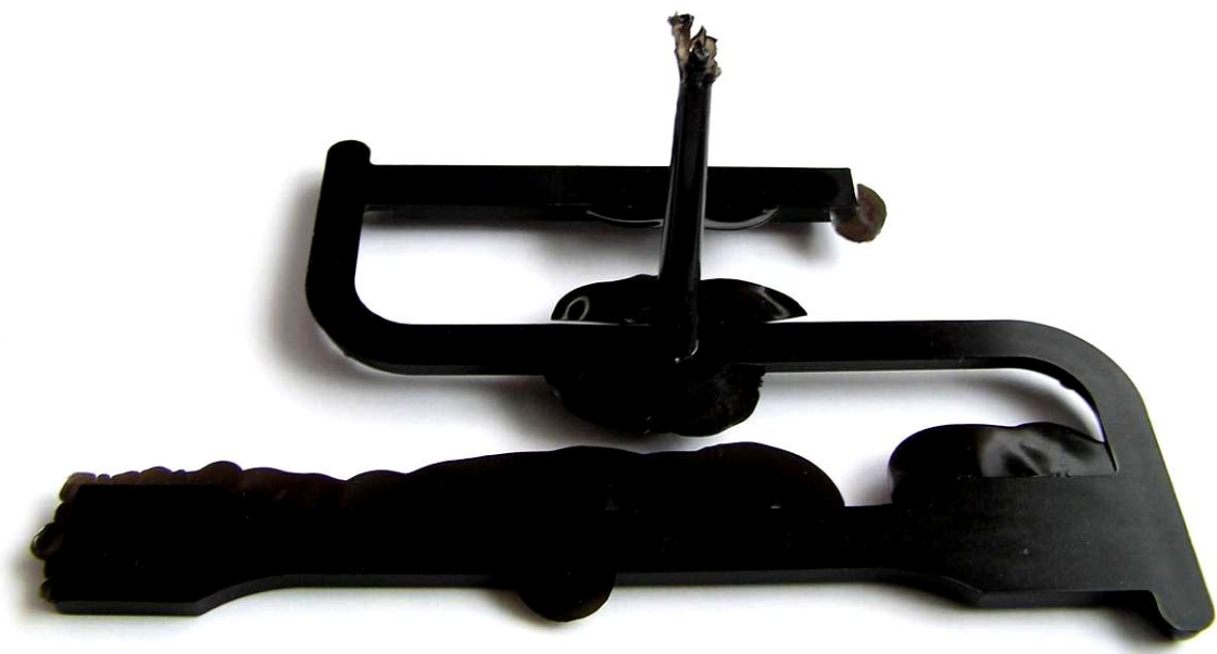
Obr. 68 PA66 – Výrobek s přetoky
