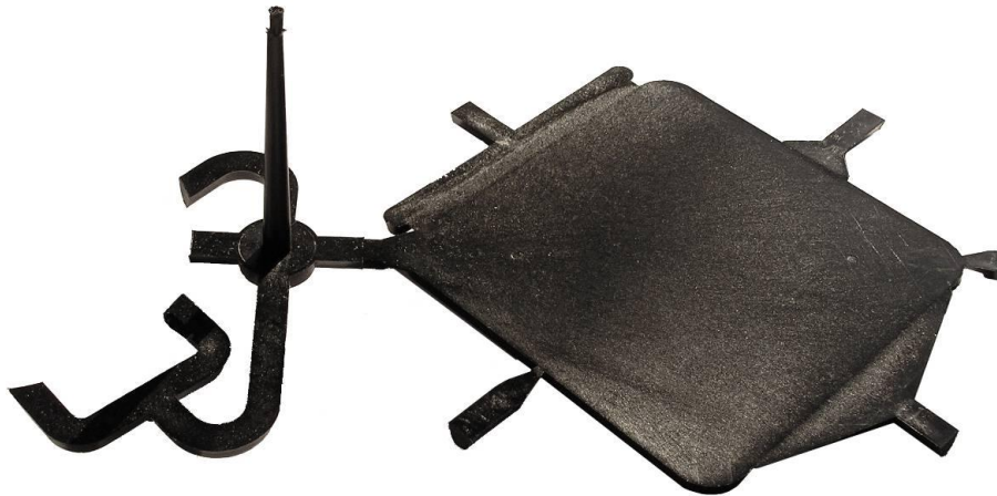
Obr. 84 PA66 + 30 % skelných vláken – konečný výrobek s rohovým filmovým vtokem
