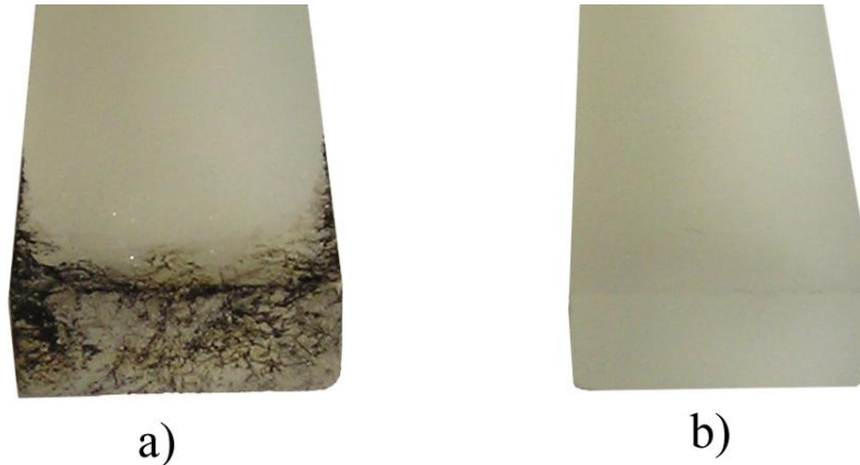
Obr. 48 Konečná eliminace vad na výstřiku a) spálené místo b) optimalizované místo
