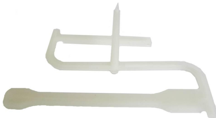
Obr. 46 PP + 30 % skelných vláken – zaplnění dutiny formy z 93 – 99%
