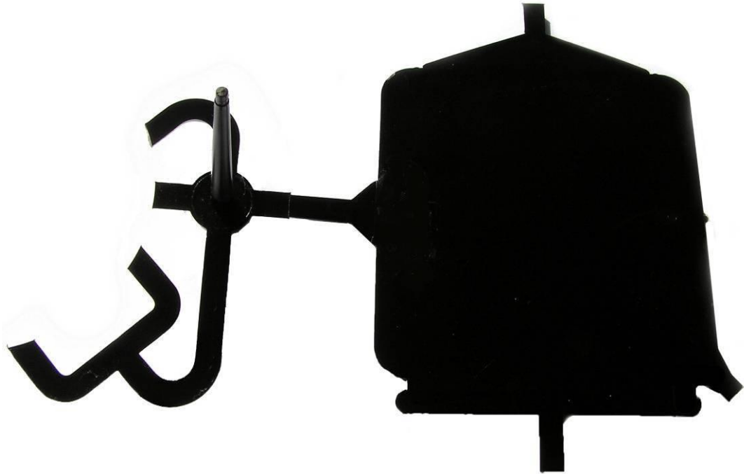
Obr. 73 PA66 – konečný výrobek s bočním vtokem
