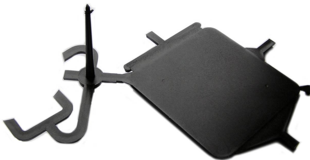
Obr. 76 PA66 + 15 % skelných vláken – konečný výrobek s rohovým filmovým vtokem
