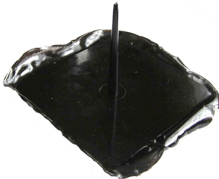
Obr. 70 PA66 – Výrobek s přetoky
