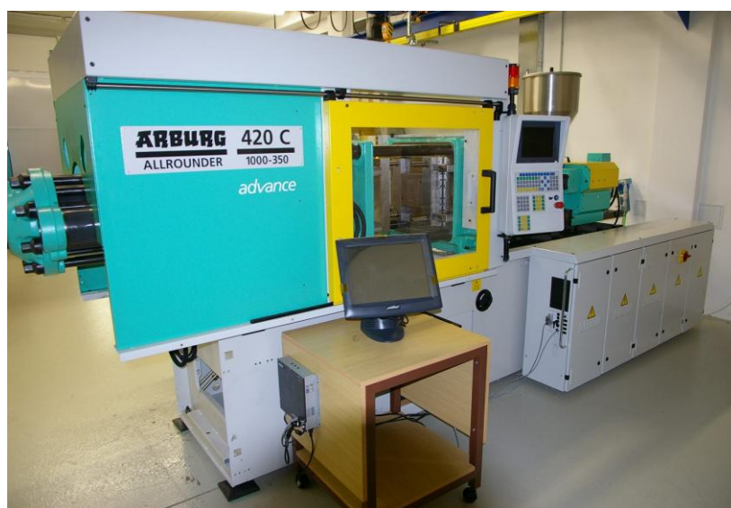
Obr. 40 Vstříkovací stroj Arburg Allrounder 420C [16]
