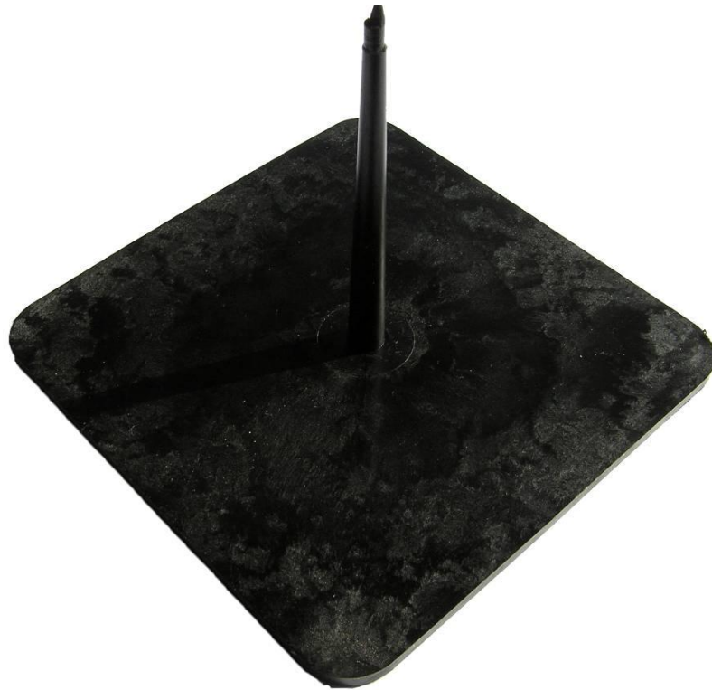
Obr. 88 PA66 + 50 % skelných vláken – vystupování skelných vláken na povrch
