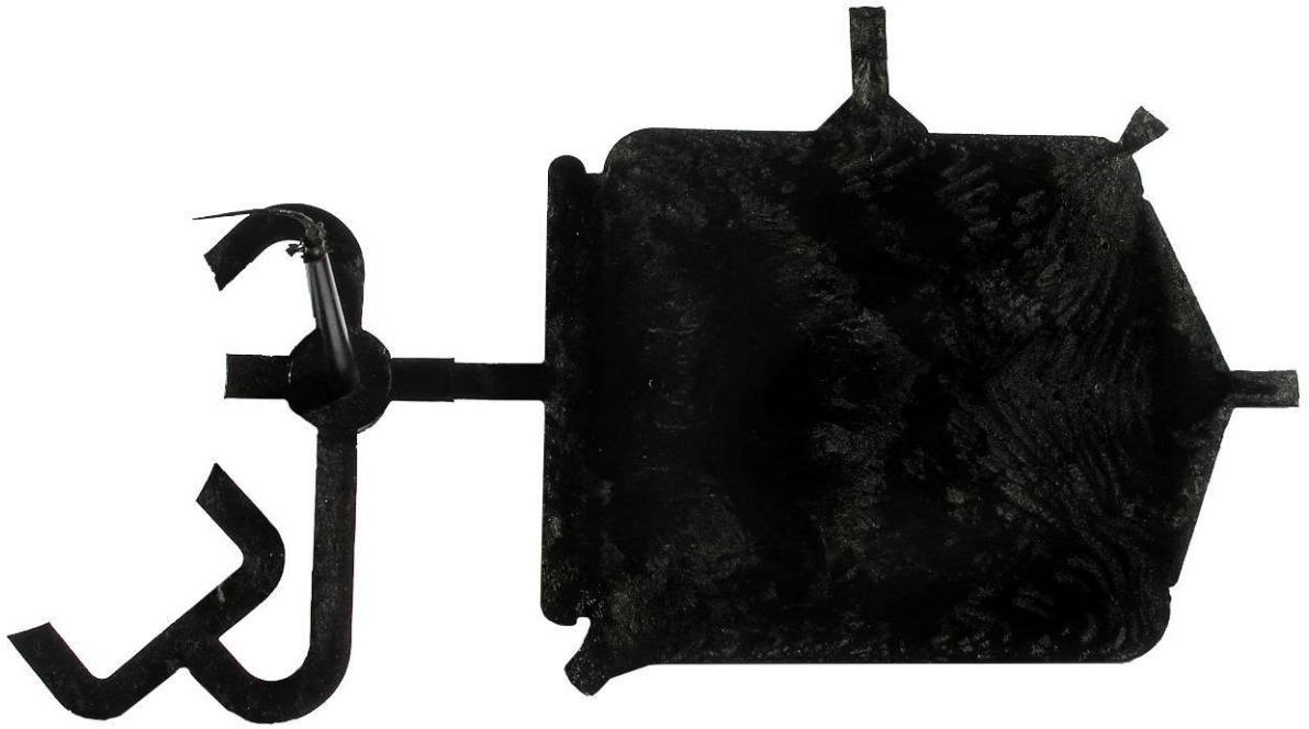
Obr. 86 PA66 + 35 % skelných vláken – konečný výrobek s širokým bočním filmovým vtokem
