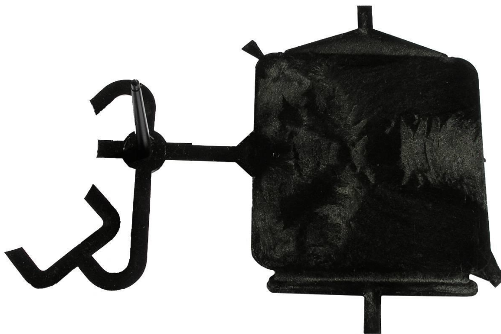
Obr. 85 PA66 + 35 % skelných vláken – konečný výrobek s bočním vtokem
