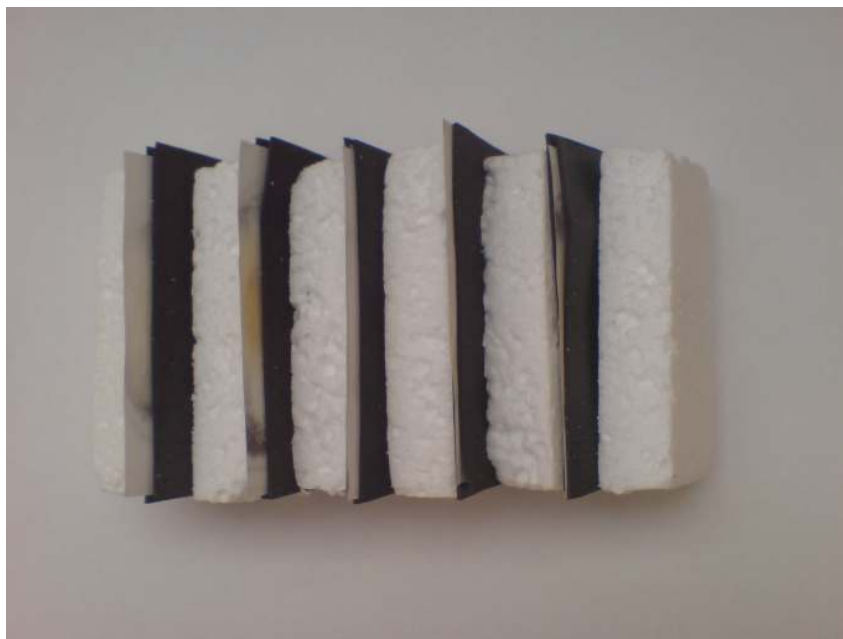
Obr. 8.3 Rozložení vrstev PS, gumy a termopapíru
