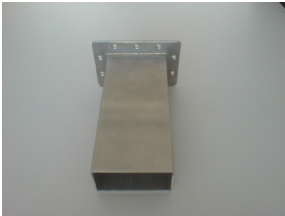
Obr. 6.2 Navržený vlnovod délky 212 mm
