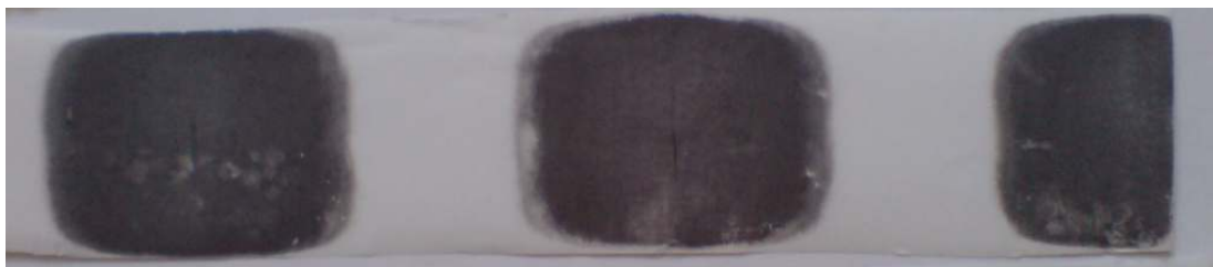
Obr. 8.7 Rozložení maxim v podélném směru vlnovod l = 610\text{mm}
