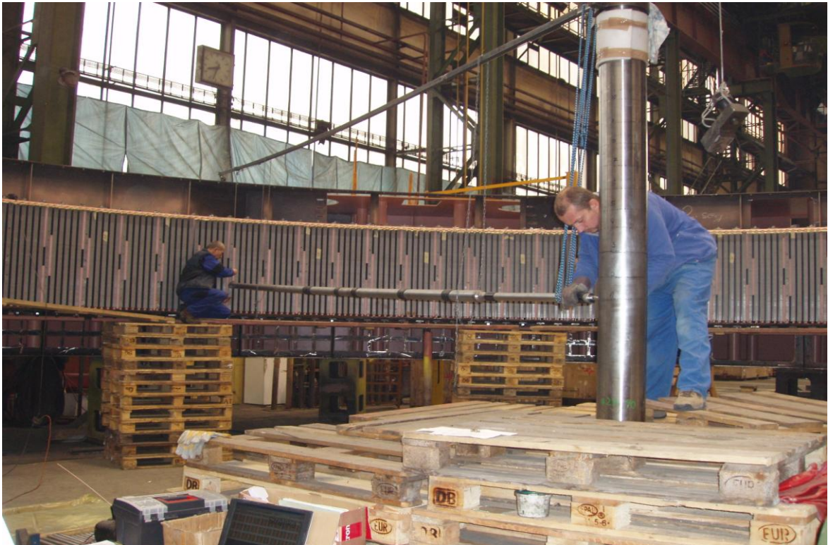
Obr.16. Měření mikrometrickým odpichem
