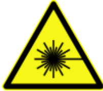
Obr. 10. Bezpečnostní symbol laseru třídy 2 a vyšší[3]
