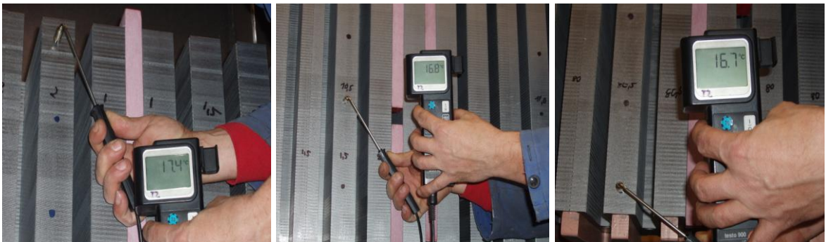
Obr.17. Měření teploty paketů ve výškových úrovních
