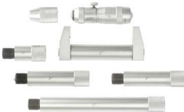
Obr.14. Sada nástavců k mikrometrickému odpichu[3]
