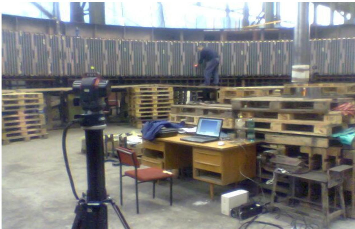
Obr.18. Snímání bodů Lasertrackerem
