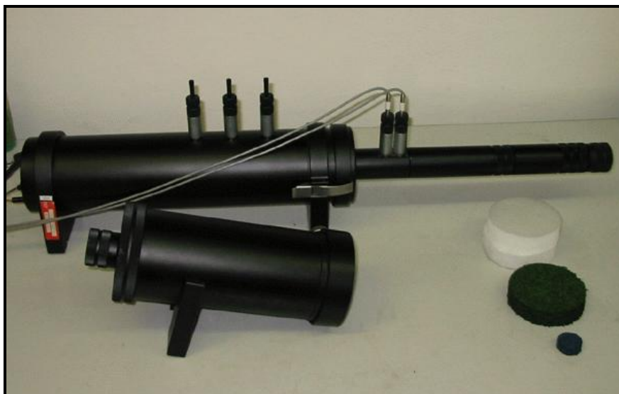
Obr. 33 Dvumikrofonová impedanční trubice Brüel & Kjaer typ 4206 [37]
