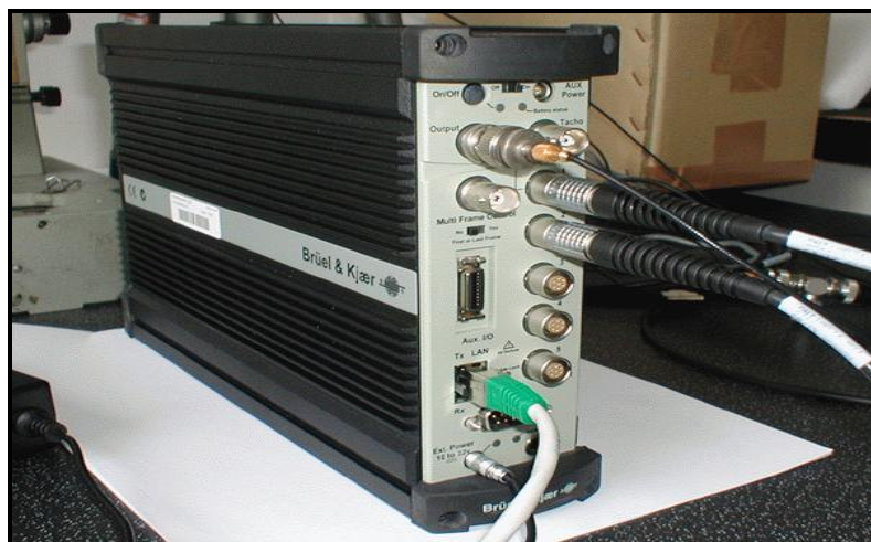
Obr. 32 Multianalyzátor Brüel & Kjaer typ 3560-B-030 [37]
