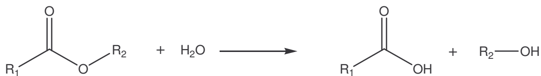
Obr. 8 Reakční schéma hydrolýzy.
