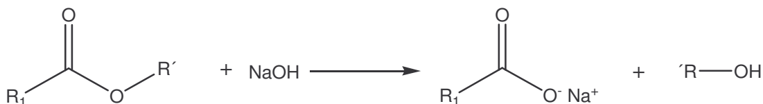
Obr. 9 Reakční schéma zmýdelnění.
