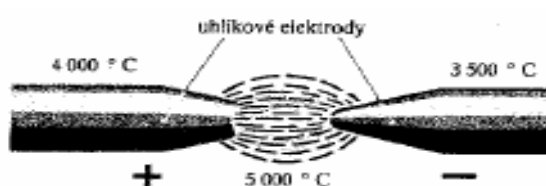
Obrázek 9 – Vznik ionizovaného vzduchu mezi elektrodami [11].
