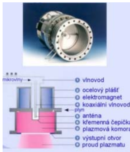
Obrázek 14 – Popis mikrovlnného zdroje plazmatu [17].
