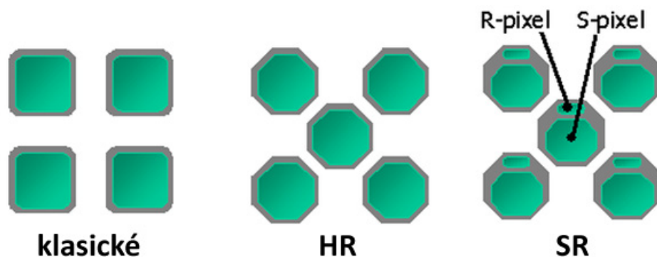
26. Uspořádání pixelů na snímačích Super CCD firmy Fujifilm
