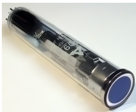
22. Nejčastěji používané snímací elektronky z 50. let značky Vidicon
