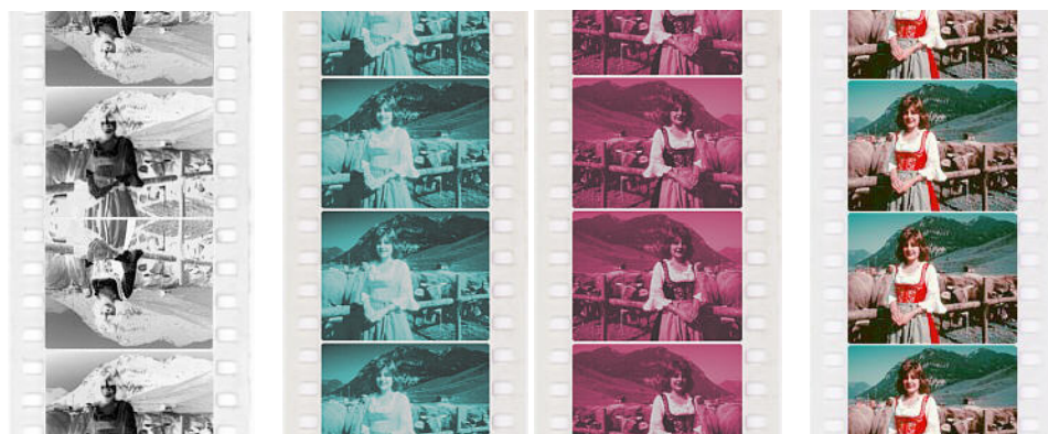
14. Nalevo je negativ exponovaný systémem Technicolor 2, uprostřed dvě obarvené pozitivní kopie a vpravo slepený, výsledný pás
