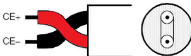
Obr. 12. Struktura základního kabelu TP1 pro KNX/EIB [7]
