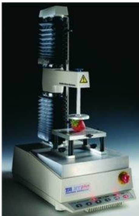
Obr. 6 Texturní analyzátor (TA.XT Plus) [35].
