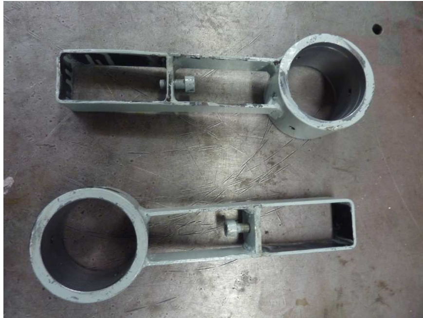
Obr. 10. Držáky pro uchycení vodící trubky
