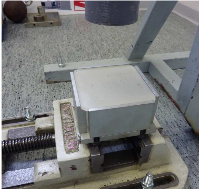
Obr. 20. Upnutý adaptér na normalizované vzorky
