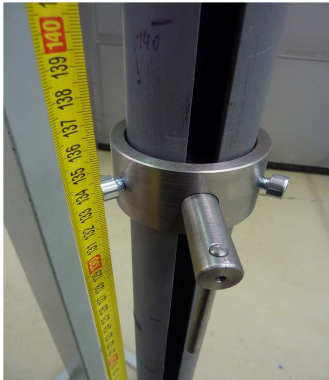
Obr. 15. Odměrování výšky polohovacího zařízení
