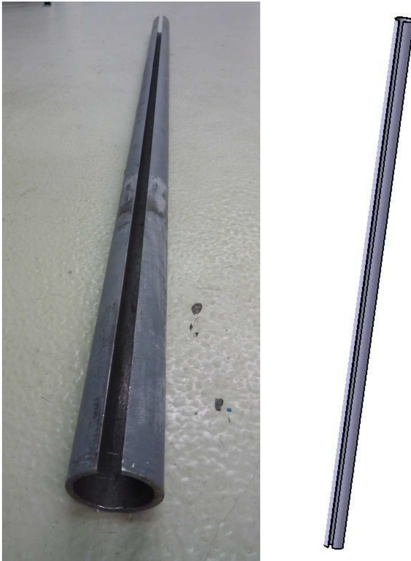
Obr. 9. Vodící trubka (vpravo 3D model Catia)
