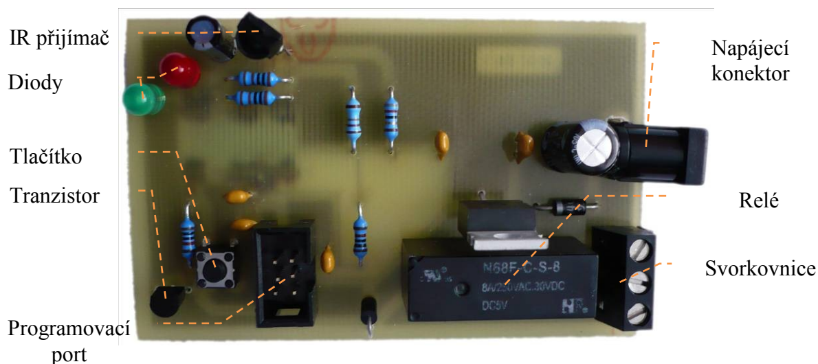
Obrázek 39 - IR přijímač ze strany součástek
