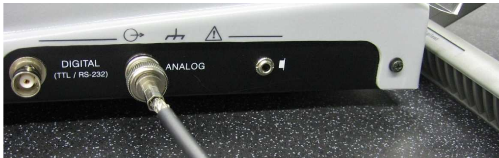
Obr. 63. Připojení prvního kanálu osciloskopu na ANALOG výstup přijímače
