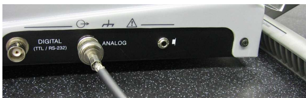
Obr. 36. Připojení prvního kanálu osciloskopu na ANALOG výstup přijímače
