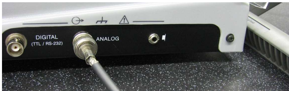
Obr. 49. Připojení prvního kanálu osciloskopu na ANALOG výstup přijímače
