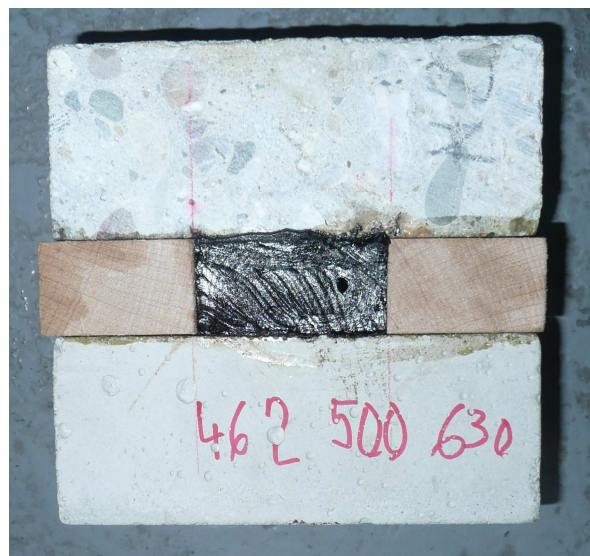
Obr. 27 Vzorek asfaltové zálivky
