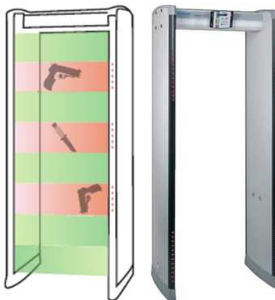
Obrázek 3: Zobrazení 8 detekčních zón a rámový detektor METOR 300 [8]
