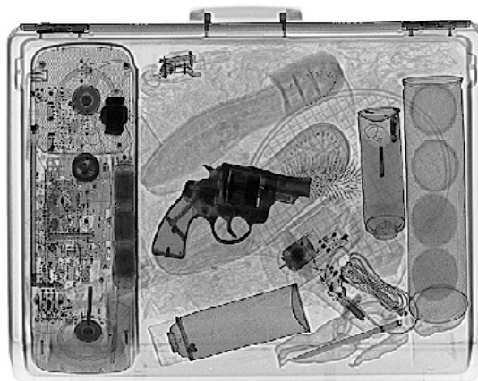
Obrázek 41: Černobílé zobrazení rentgenového přístroje [17]
