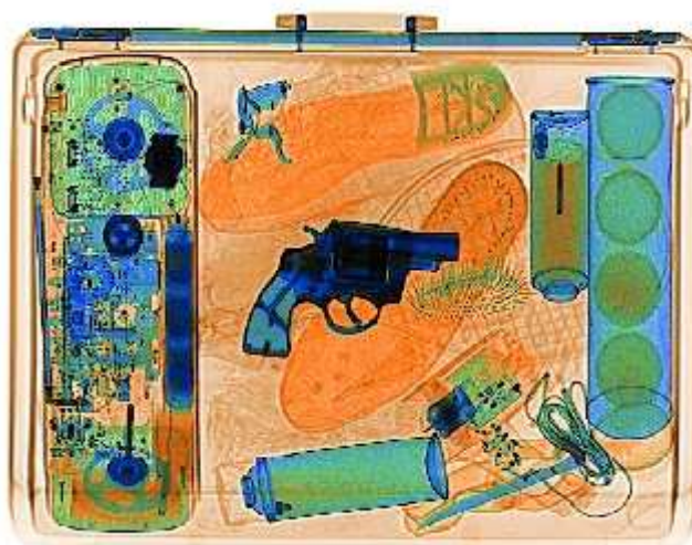
Obrázek 13: Výsledný rentgenový obraz – technologie energetického rozlišení
