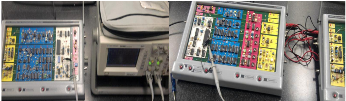
Obrázek 59: Propojení modulů pomocí dvojlinky a sondy osciloskopu
