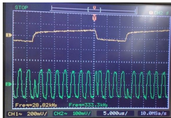
Obrázek 88: Modulovaný signál pro DPSK
