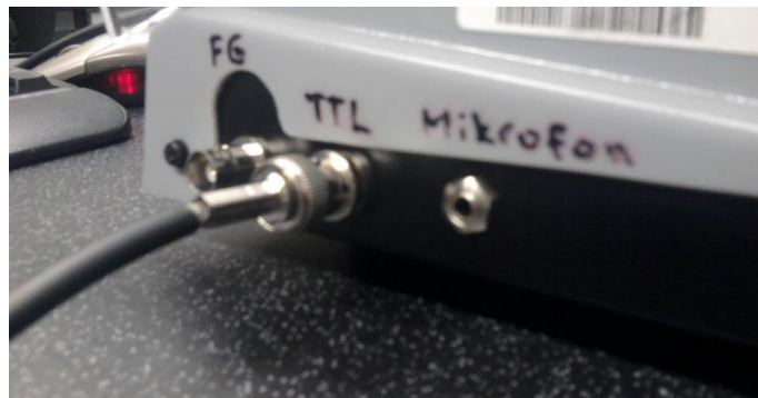
Obrázek 139: Propojení generátoru se vstupem vysílače BNC2 (TTL)
