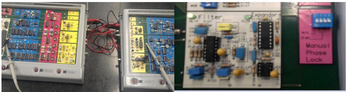
Obrázek 68: Propojení modulů dvojlinkou a SW3 mikro-přepínač OFF
