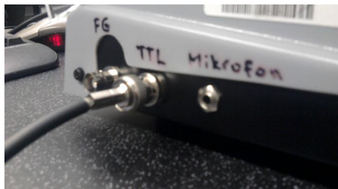
Obrázek 60: Propojení generátoru s vysílačem na vstup (BNC2)
