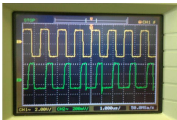
Obrázek 73: Získaný signál na vysílači TPE15 a přijmači TPR13
