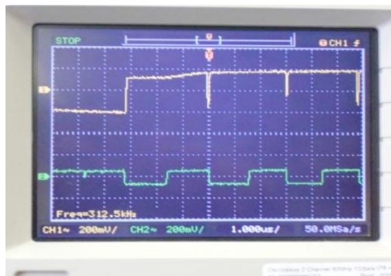
Obrázek 109: Sondy osciloskopu na TPR30 a TPR31 (XOR výstup)
