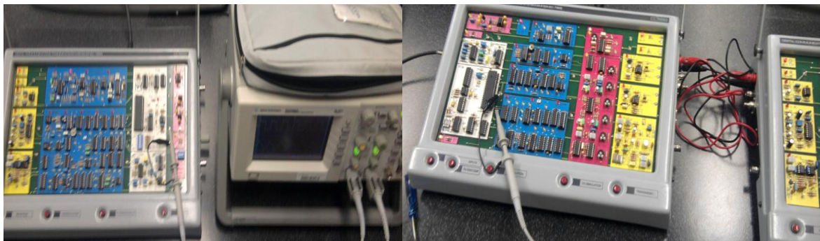
Obrázek 138: Propojení modulů pomocí dvojlinky a umístění sond osciloskopu
