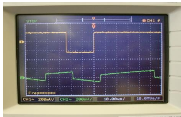
Obrázek 106: Diferenciálně kódovaný dibits na bodech TPE22 a TPE23
