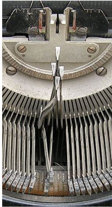
Obr. 10 Zaseknuté paličky psacího stroje
