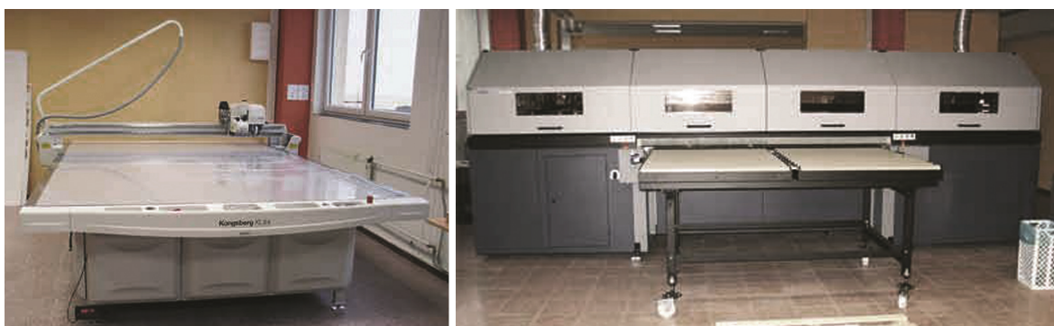
Obrázek 12 Velkoformátový řezací plotr Kongsberg XL 44 a digitální UV tiskový stroj Durst Rho 700 Presto
