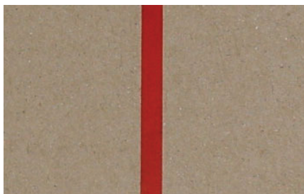
Obrázek 6 Plastová trhací páska v materiálu
