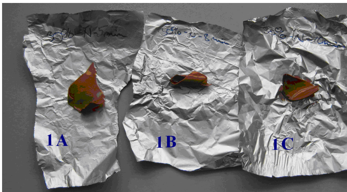
Obr. 20 Nepotřené vzorky po síťování (doba A - 5 minut ; B - 8 minut ; C - 10 minut při 180 °C) [30]
