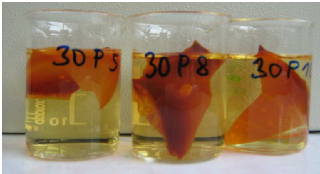
Obr. 29 Potřené vzorky vložené do kádinky s destilovanou vodou (síťováno při 180 °C doba 30P5 - 5minut ; 30P5 - 8 minut ; 30P5 - 10 minut) doba ponoření 20 hodin [30]
