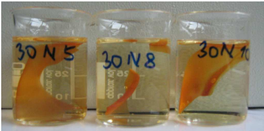
Obr. 26 Nepotřené vzorky vložené do kádinky s destilovanou vodou (sít'ováno při 180 °C doba 30N5 - 5minut ; 30N8 - 8 minut ; 30N10 - 10 minut ) doba ponoření 3 hodiny [30]
