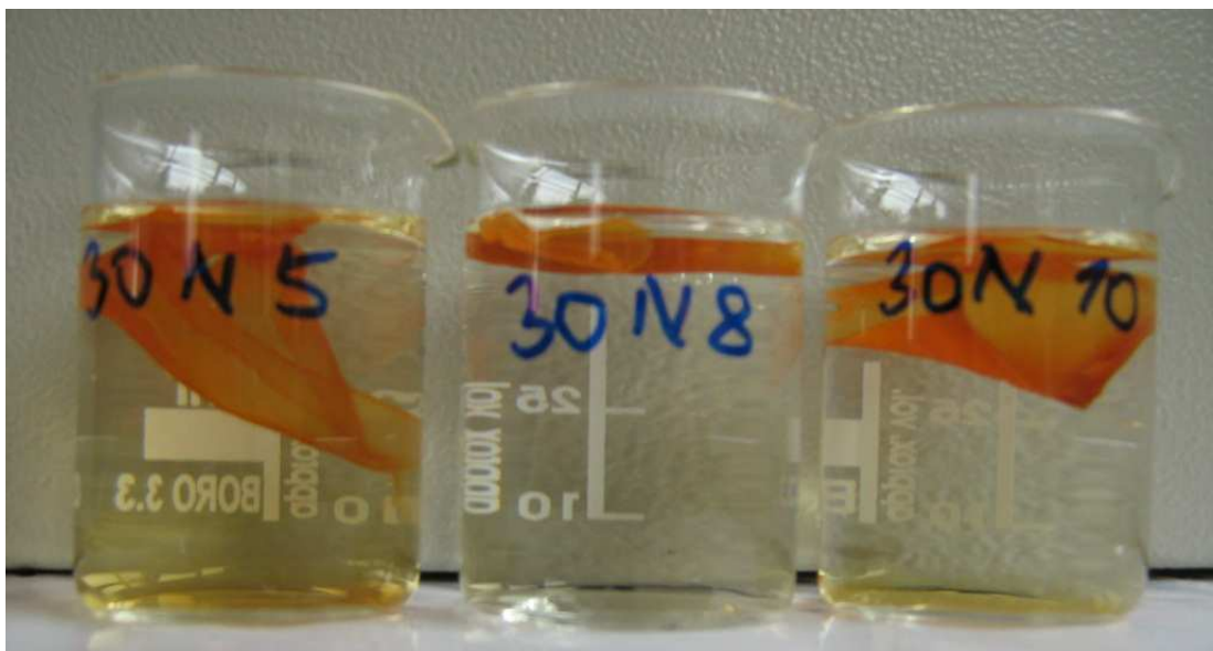
Obr. 24 Nepotřené vzorky vložené do kádinky s destilovanou vodou (sít'ováno při 180 °C doba 30N5 - 5minut ; 30N8 - 8 minut ; 30N10 - 10 minut ) doba ponoření 20 minut [30]
