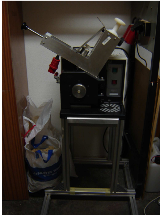
Obr. 35 Mlecí zařízení - nožový mlýn Fritsch Pulverisette 19 na pracovišti UIP UTB ve Zlíně
