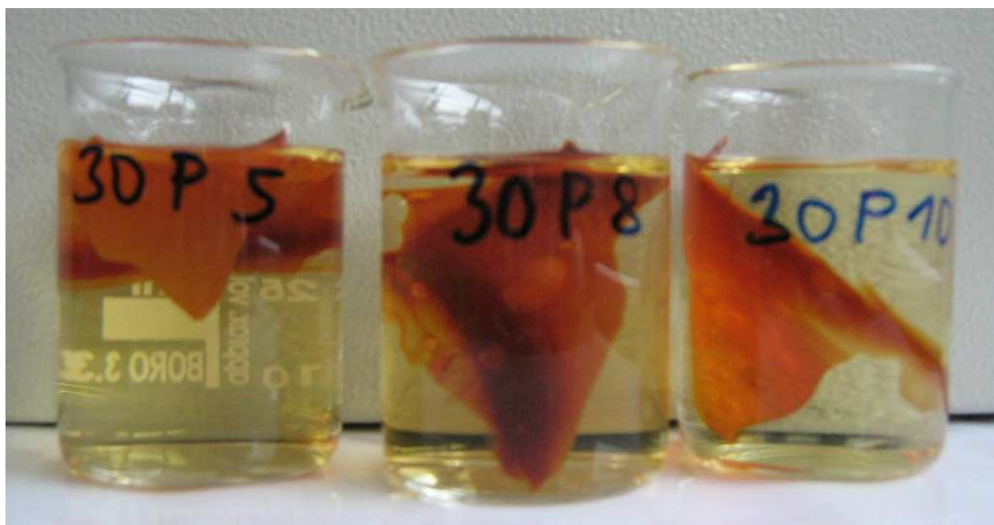
Obr. 27 Potřené vzorky vložené do kádinky s destilovanou vodou (sít'ováno při 180 °C doba 30P5 - 5minut ; 30P5 - 8 minut ; 30P5 - 10 minut) doba ponoření 3 hodiny [30]
