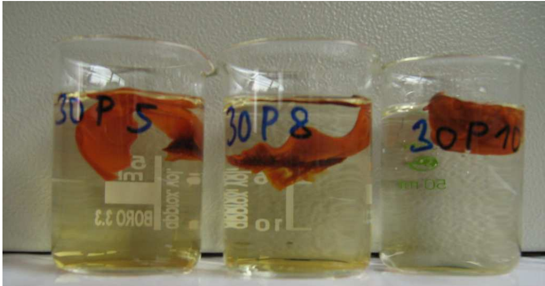
Obr. 25 Potřené vzorky vložené do kádinky s destilovanou vodou (sít'ováno při 180 °C doba 30P5 - 5minut ; 30P5 - 8 minut ; 30P5 - 10 minut) doba ponoření 20 minut [30]
