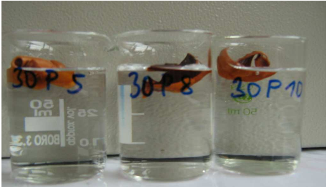
Obr. 23 Potřené vzorky vložené do kádinky s destilovanou vodou (sít'ováno při 180 °C doba 30P5 - 5minut ; 30P5 - 8 minut ; 30P5 - 10 minut) ihned po ponoření [30]
