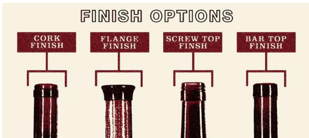
Obr.21 / Typ hrdel v porovnání /zleva: hrdlo OB, hrdlo AQ, hrdlo šroubovací, hrdlo OBM
