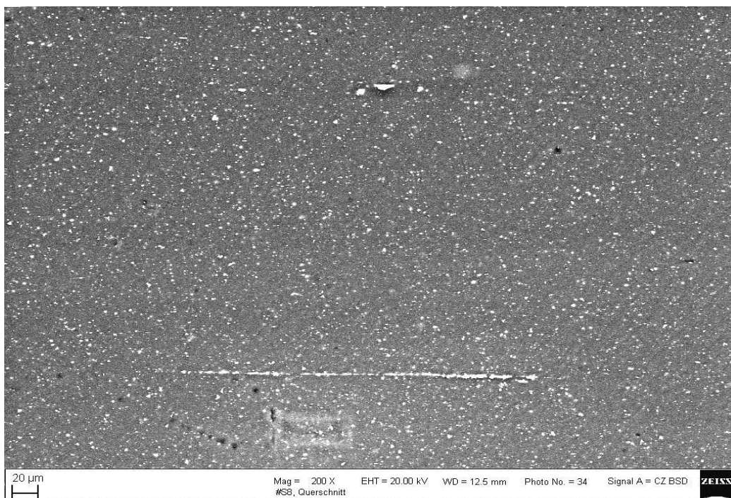
Obr. 57.: Mikroskopie řezu vzorku OT 33 – C bez sazí (zvětšení 200x)
