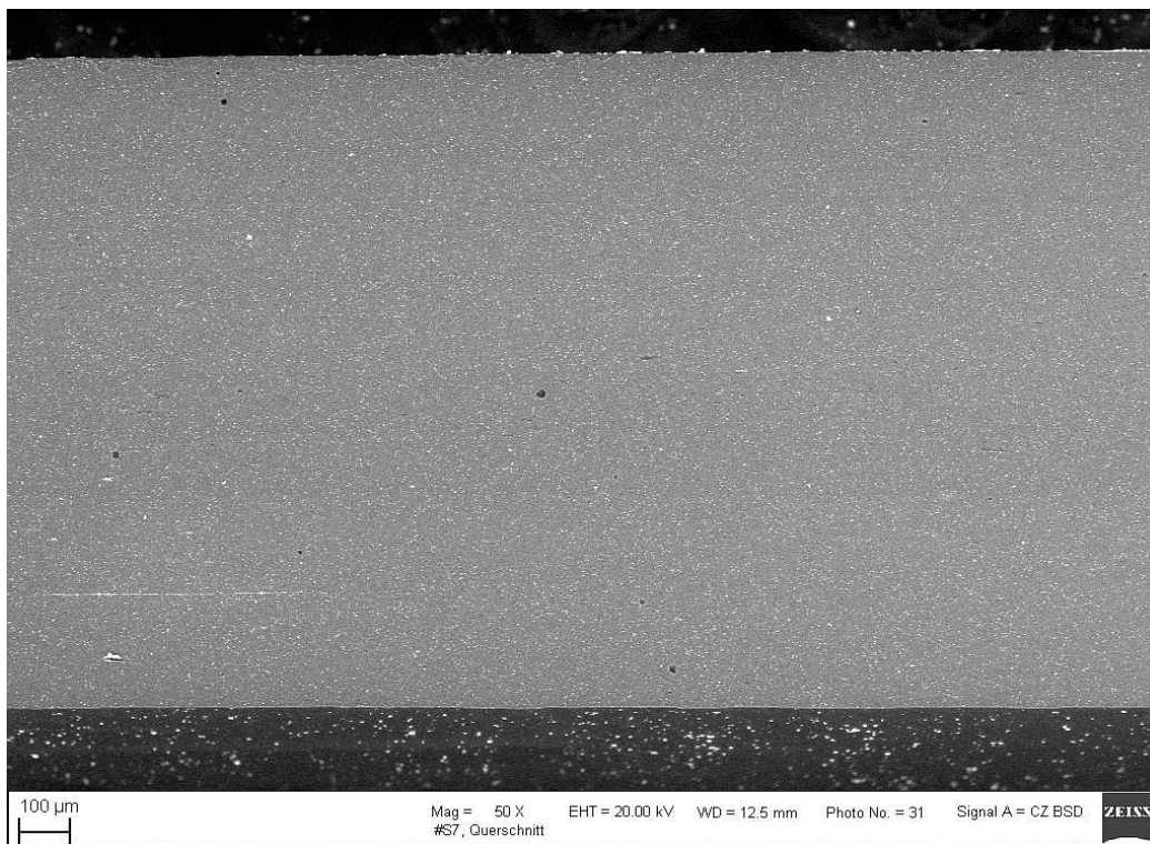
Obr. 54.: Mikroskopie řezu vzorku OT 38 – P (zvětšeno 50x)
