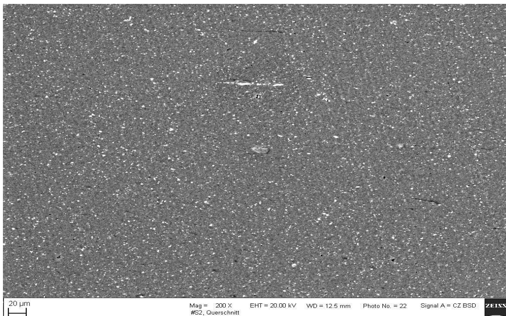
Obr. 45.: Mikroskopie řezu vzorku OT 20 – HD (zvětšeno 200x)
