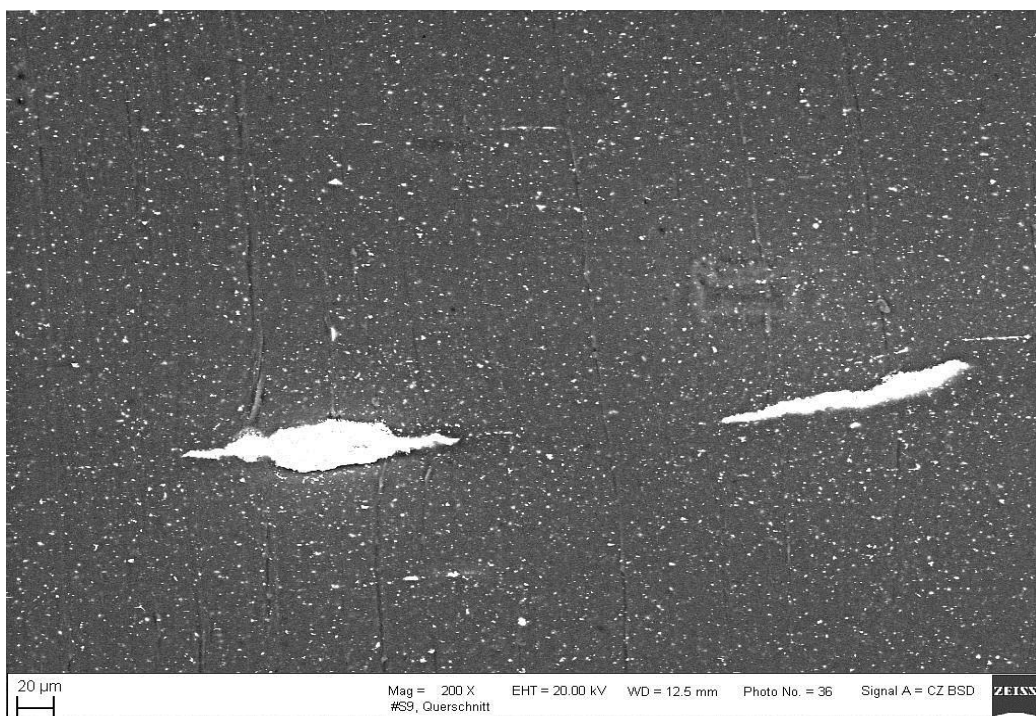
Obr. 59.: Mikroskopie řezu vzorku OT 33 – F bez sazí (zvětšení 200x)
