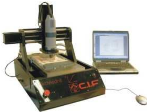
Obrázek 12. NC stroj pro frézování tvarových ploch [6]
