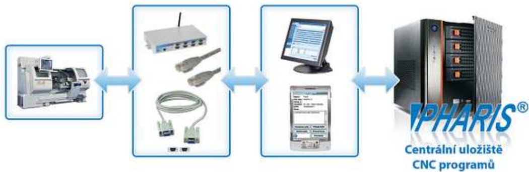
Obrázek 19. DNC řízení – Přímé číslicové řízení [11]
