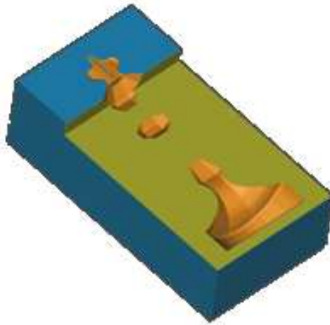
Obrázek 63. Negativ po obrábění „načisto“
