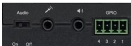
Obrázek 24: IP kamera Cisco VC220 – vstupy a výstupy [29]
