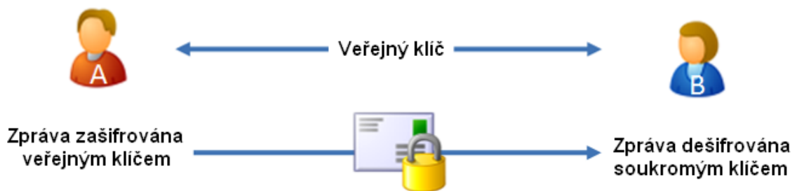
Obrázek 4: Princip asymetrického šifrování pomocí soukromého a veřejného klíče [vlastní tvorba]
