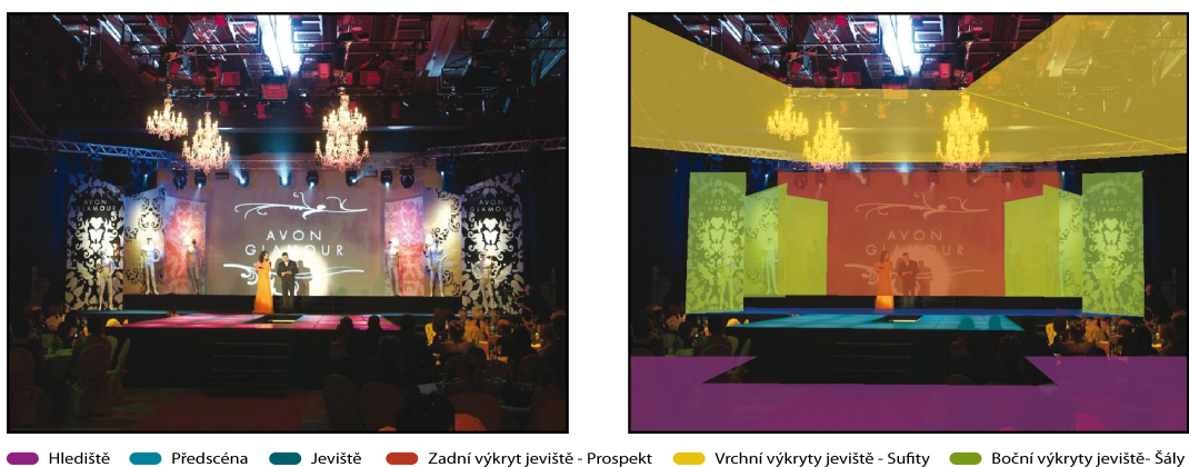
Obr. 6. - Schéma scénického řešení veřejného eventu - Avon Glamour v prostorách hotelu Hilton Praha
