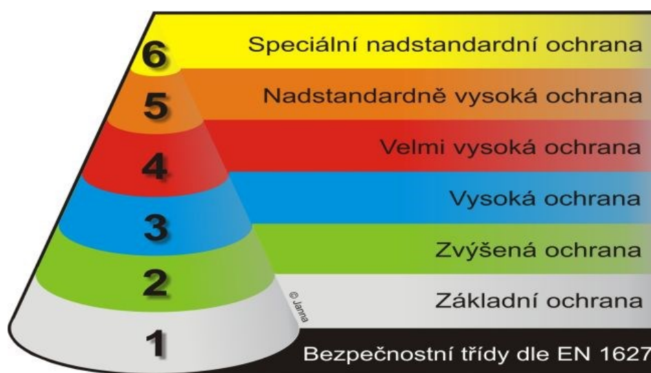
Obr. 37 Třídy odolnosti dle ČSN EN 1627
