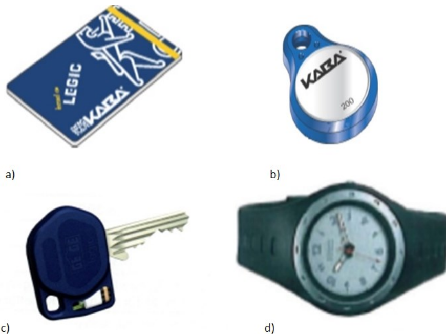
Obr. 61 Média používané v mechatrických přístupových uzamykacích systémech a) karta b) přívěšek s čipem c) klíč s nalisovaným clipem d) hodinky s umístěným čipem
