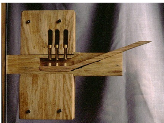
Obr. 30 Zámkový systém s padajícími stavítky
