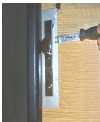
Otevírání střelky pomocí nástroje na ovládání čtyřhranu kliky a jeho nasunutím pod štít
