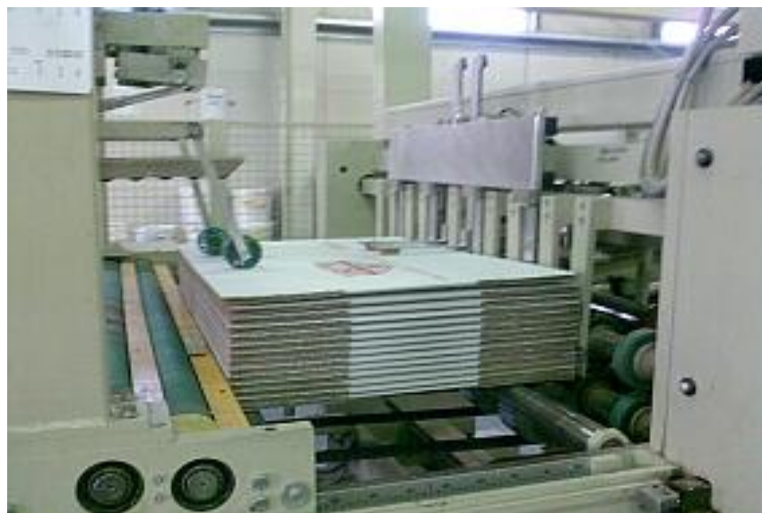
Obrázek 3: Stroj CURIONI-stohovací výstupní zařízení (vlastní foto)
