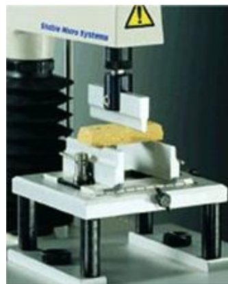
Obr. 19. Tříbodová zkouška ohybem [28]
