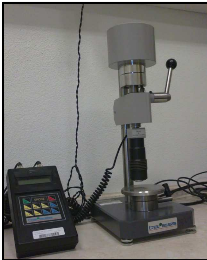
Obr. 36. Tvrdoměr Shore D s digitálním výstupem HHP-2001
