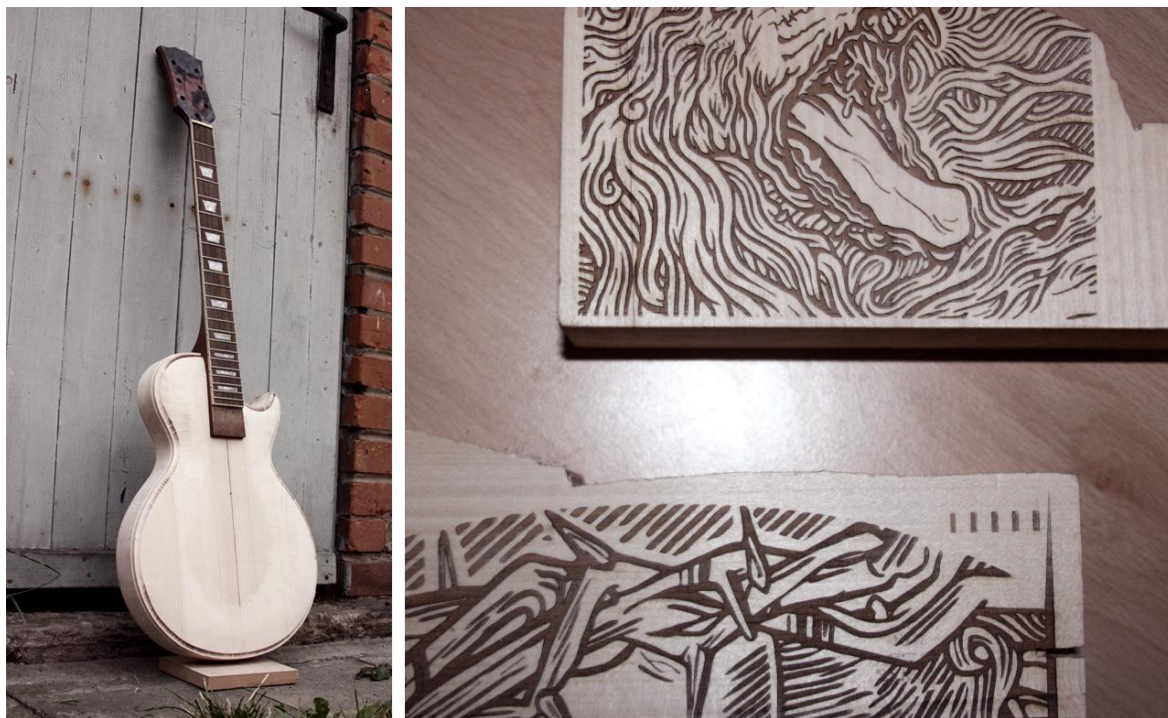
Obrázek 8-2-2: Korpus kytary a laserové zkoušky
