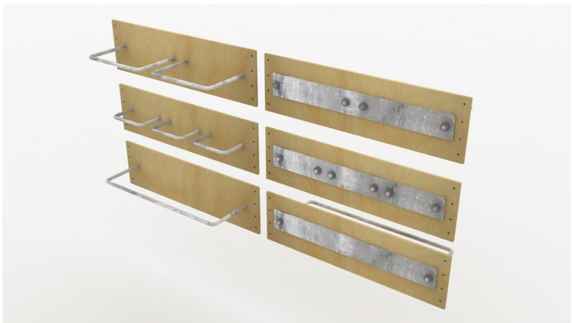
Obrázek 46. Detail- uchycení nosných trubek
