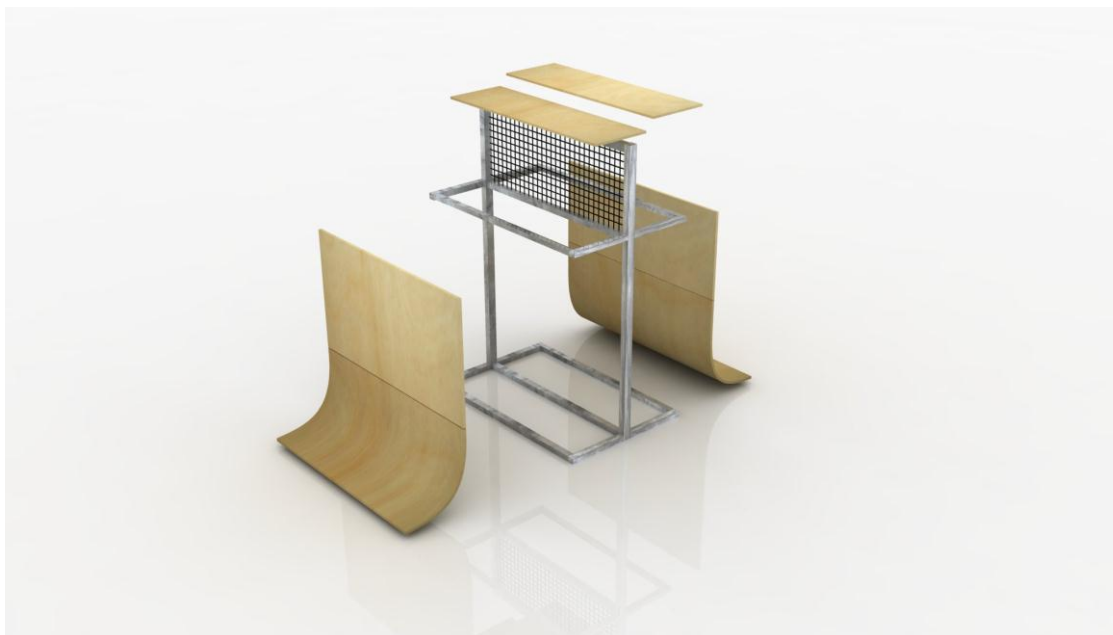
Obrázek 53. Konstrukce prostorového stojanu
