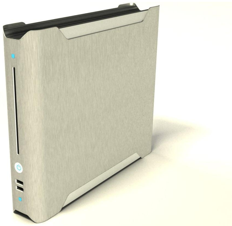
Obrázek 4-4 Finální řešení skříně se zapuštěnými profily
