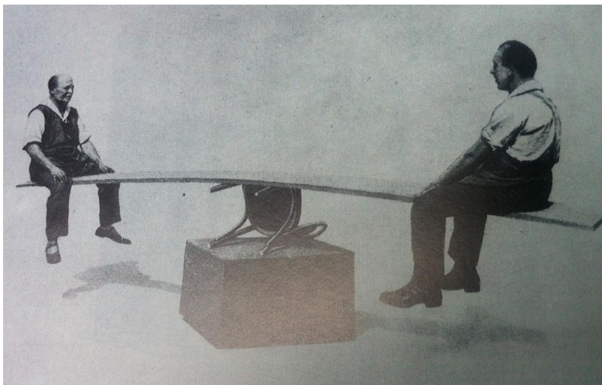
Obrázek č. 5 Demonstrace pevnosti ohýbané židle, TON
