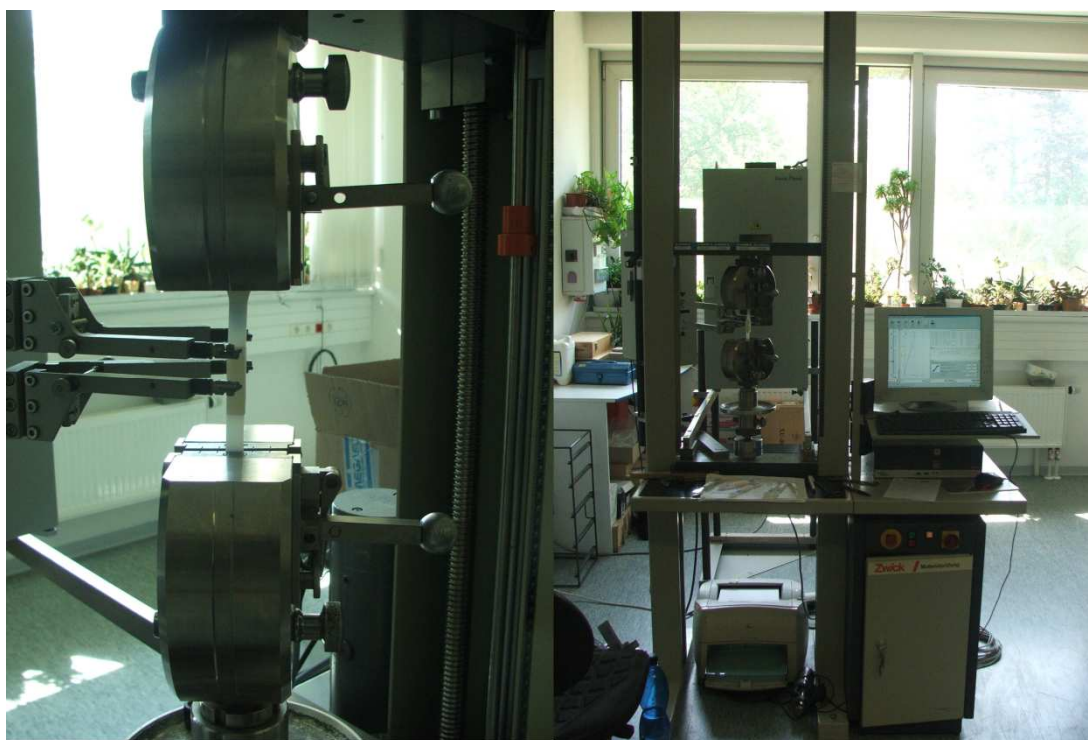
Obr. 18. Trhací stroj zwick a způsob upnutí tělesa
