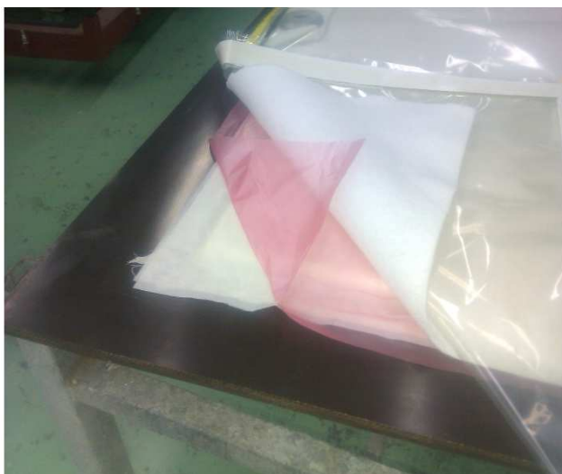
Obrázek 19 – Uspořádání jednotlivých vrstev na formě
