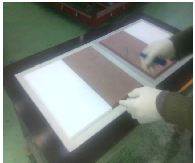
Obrázek 19 – Uspořádání jednotlivých vrstev na formě
