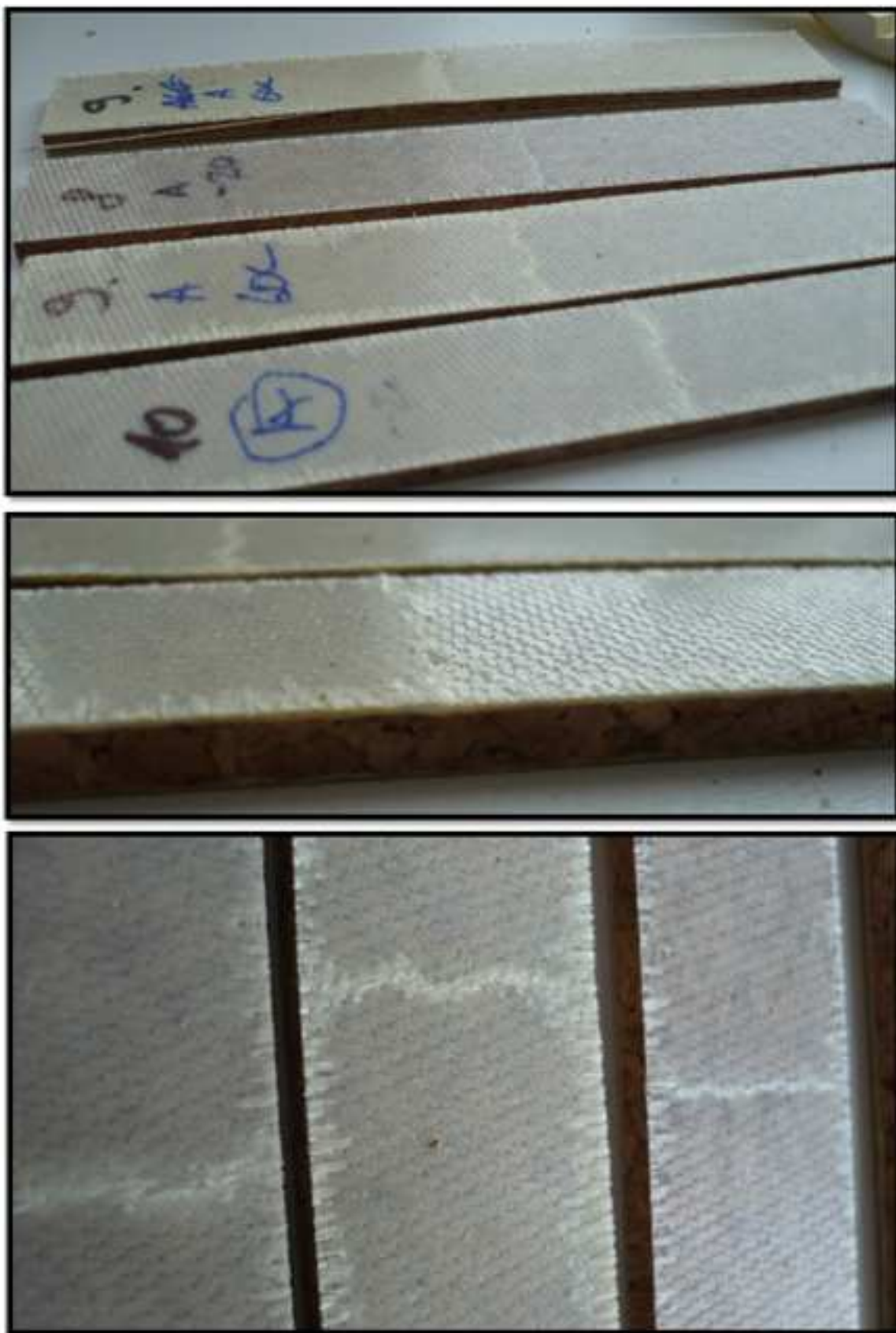
Obrázek 55 – Změny vnitřních a povrchových struktur – Corekork NL
