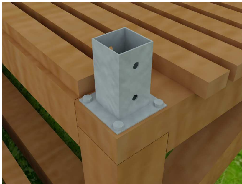
Obr. 46. Jeden z návrhů ukotvení zastřešení, vizualizace
