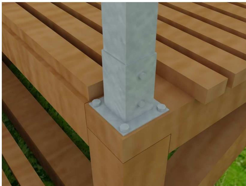
Obr. 47. Jeden z návrhů ukotvení zastřešení, vizualizace
