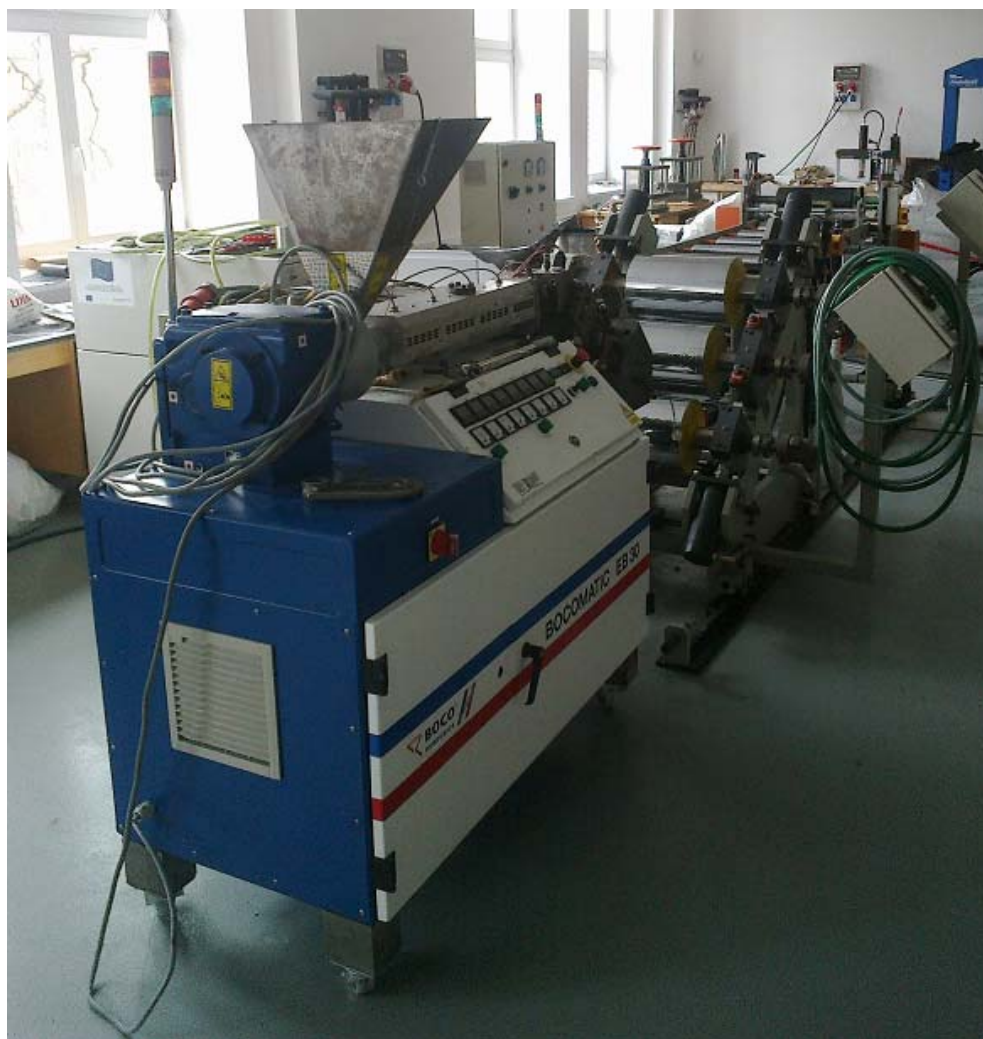
Obrázek 11: Laboratorní vytlačovací linka
