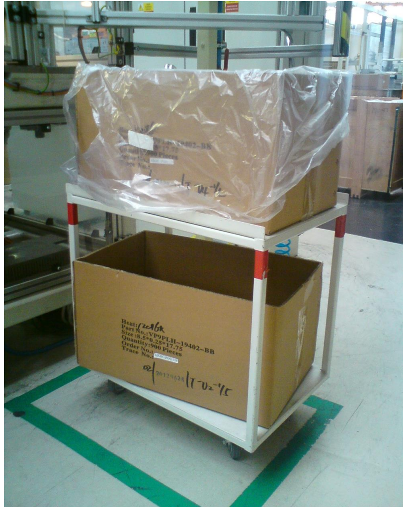
Obrázek 19: Upravený vozík na jednu bednu s prostorem pro odložení odpadového obalu (vlastní zpracování)
