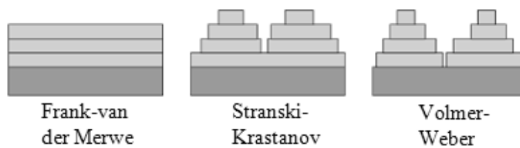
Obr. 13. Způsoby růstu při epitaxiální krystalizaci [31]
