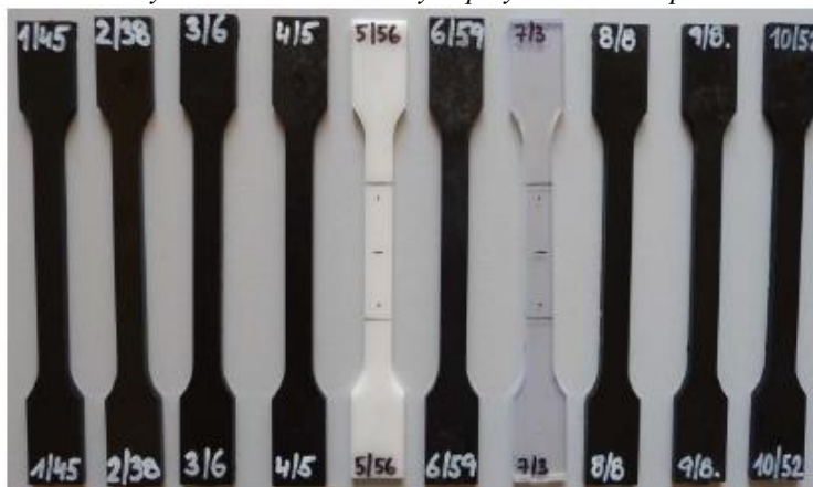
Obr. 4 vzorky deseti druhů zkoušených polymerních kompozitů
